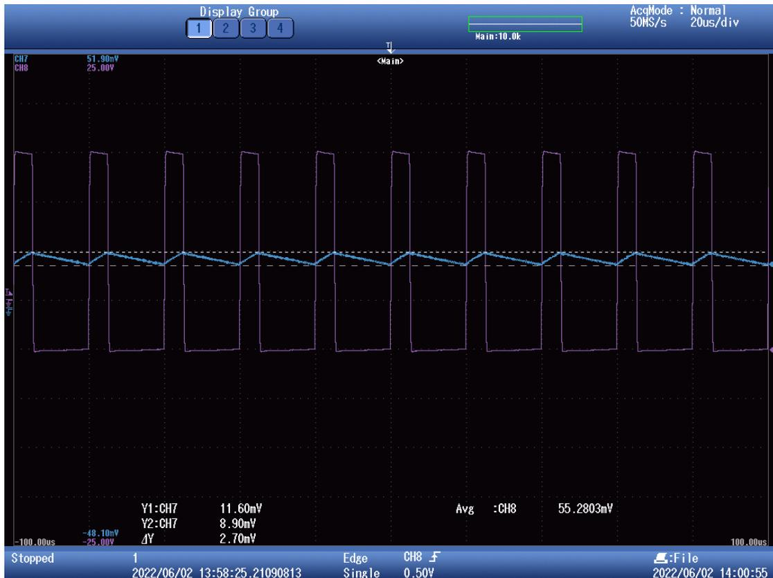
Figura 69. Tensión (morado) e intensidad (azul) en la bobina con tensión de referencia a la salida de 5V (III).
