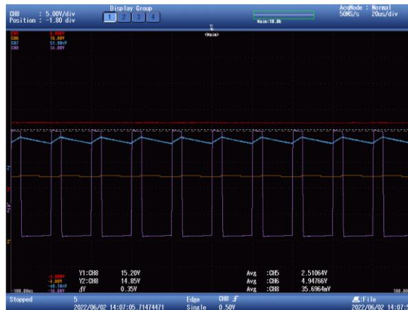
Figura 70. Tensión e intensidad de la bobina, tensión a la entrada del microprocesador y tensión en la salida.
