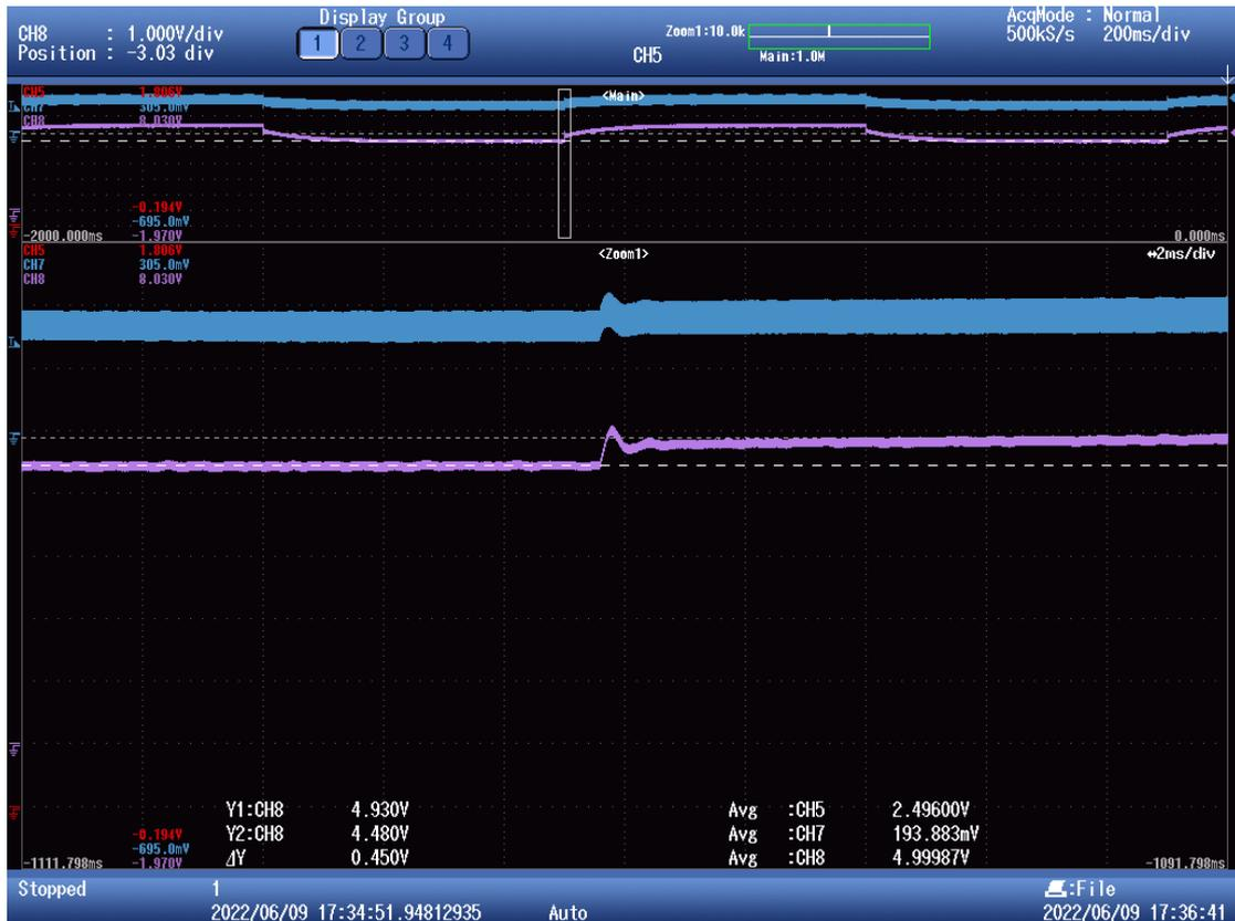
Figura 91. Régimen transitorio con resistencia shunt de  $0.23\Omega$  (I). Tensión en la salida (morado) e intensidad en la bobina (azul).
