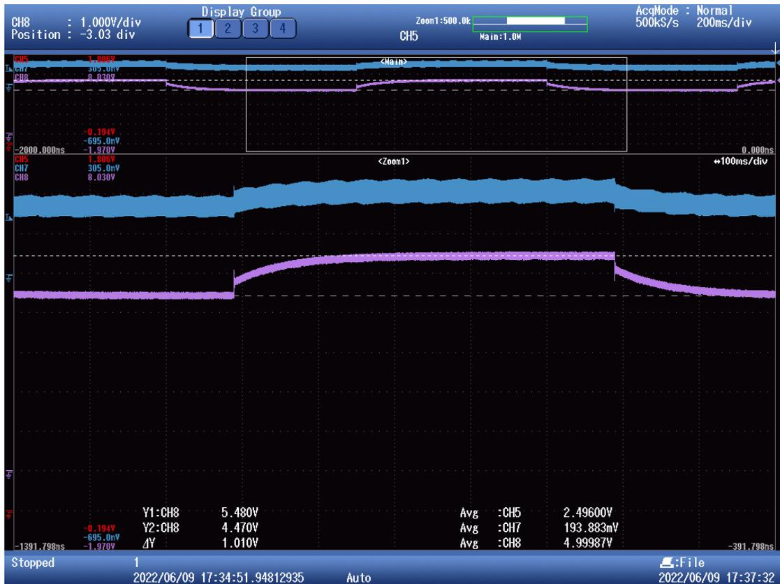
Figura 92. Régimen transitorio con resistencia shunt de  $0.23\Omega$  (II). Tensión en la salida (morado) e intensidad en la bobina (azul).
