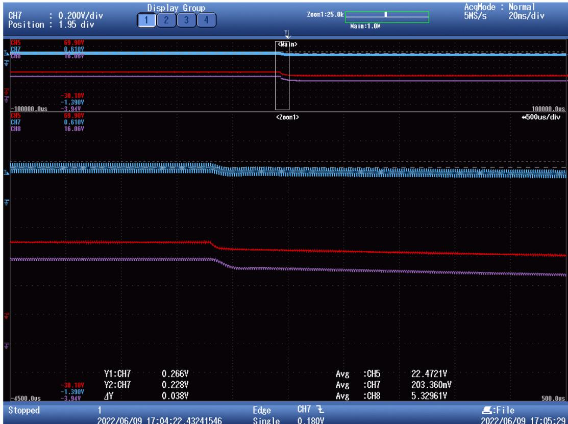
Figura 85. Escalón en la tensión de entrada en lazo abierto. Tensión en la salida (morado), tensión en la entrada (rojo) e intensidad en la bobina (azul).
