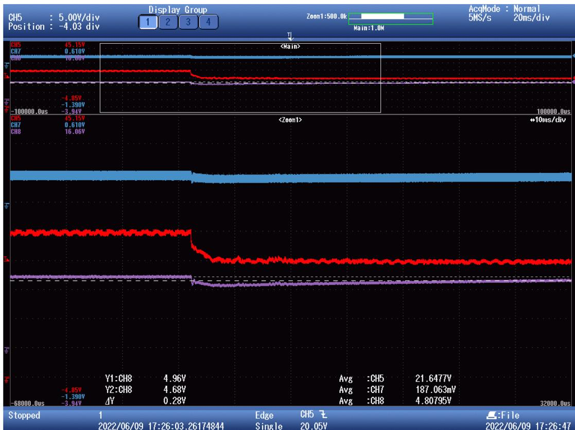
Figura 90. Escalón en la entrada en lazo cerrado (III). Tensión en la salida (morado), tensión en la entrada (rojo) e intensidad en la bobina (azul).
