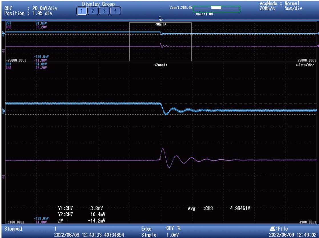
Figura 80. Escalón en la carga con lazo abierto (III). Tensión en la salida (morado) e intensidad en la bobina (azul).
