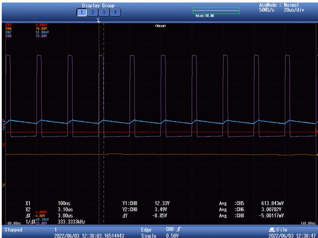
Figura 76. Respuesta a tensión de referencia en la salida (naranja) de 3V.
