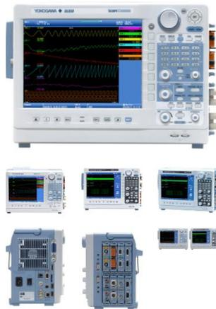
*Figura 25. Osciloscopio DL850 de Yokogawa. Imagen recortada de la página de Yokogawa de este producto. (De [9]).*
