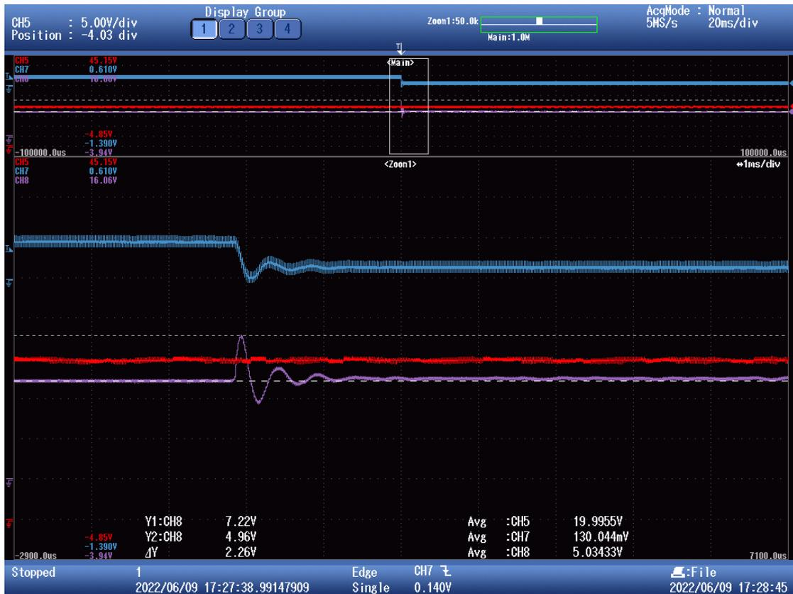
Figura 87. Escalón en la carga en lazo cerrado (II). Tensión en la salida (morado), tensión en la entrada (rojo) e intensidad en la bobina (azul).
