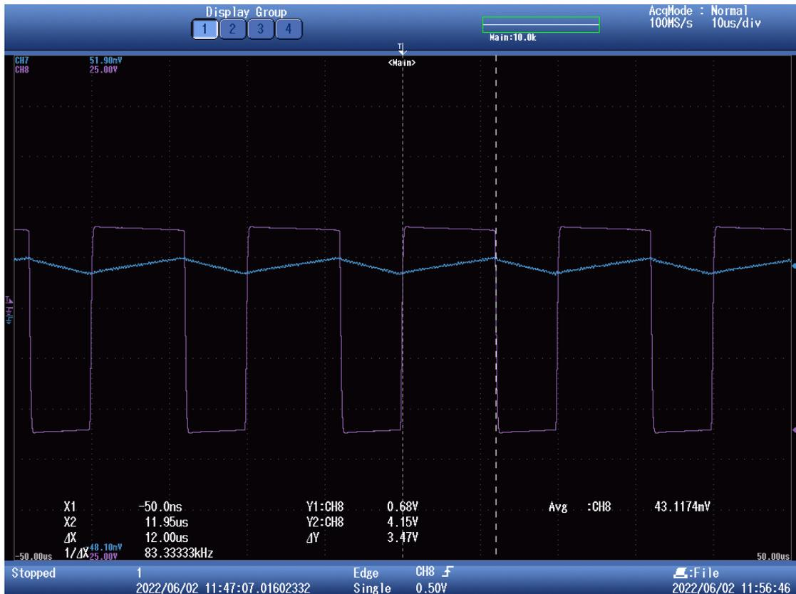
Figura 61. Tensión (morado) e intensidad (azul) en la bobina con Voref 12V. Medida del tiempo de la tensión cuando tiene valor positivo o T1 ON con los cursores.
