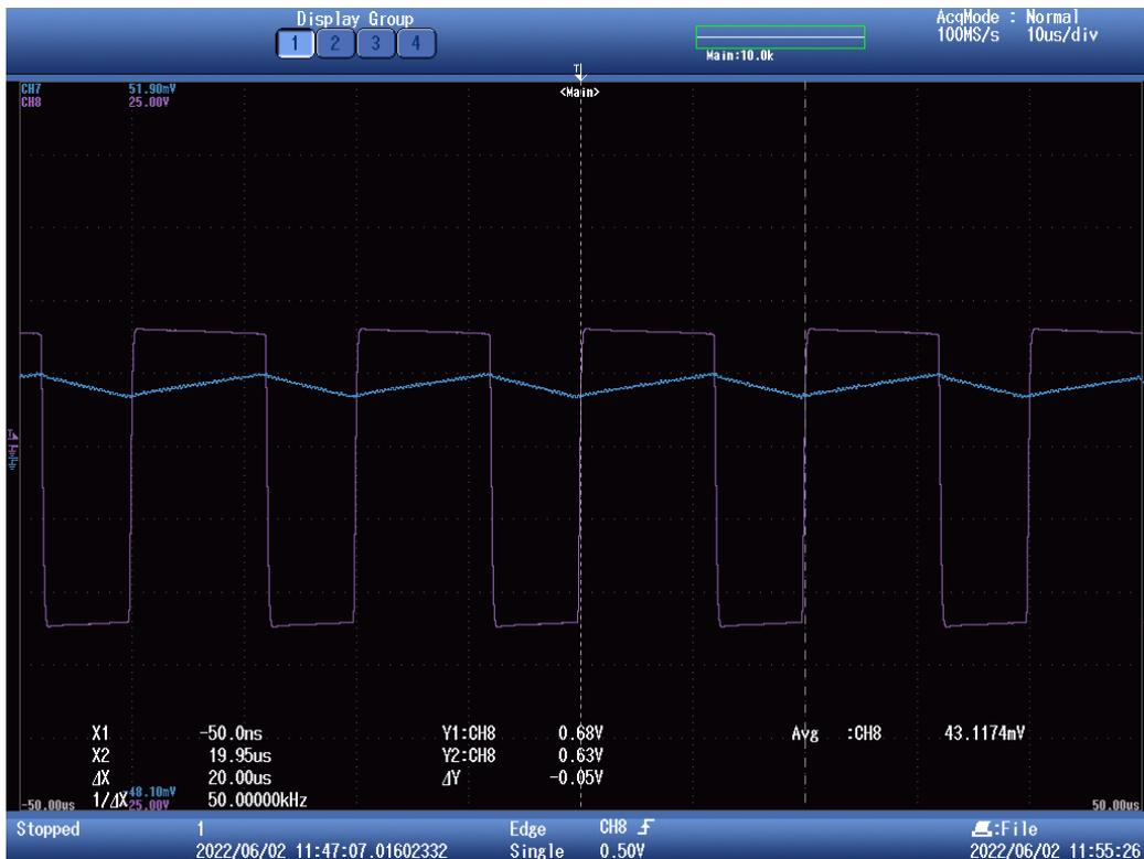
Figura 60. Tensión (morado) e intensidad (azul) en la bobina con Voref 12V. Medida del periodo de la tensión de la bobina con cursores.
