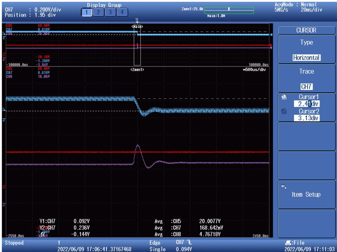
Figura 84. Escalón en la carga con lazo abierto y nueva resistencia shunt (III). Tensión en la salida (morado), tensión en la entrada (rojo) e intensidad en la bobina (azul).
