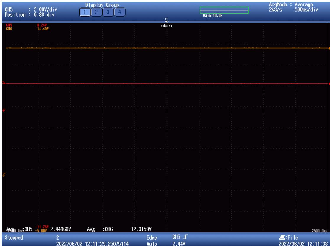
Figura 64. Tensión en la carga (naranja) y en la entrada del microprocesador (rojo).
