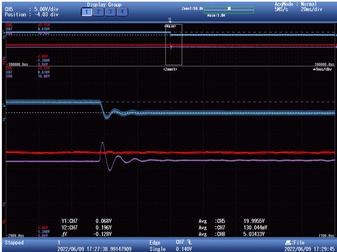
Figura 86. Escalón en la carga en lazo cerrado (I). Tensión en la salida (morado), tensión en la entrada (rojo) e intensidad en la bobina (azul).
