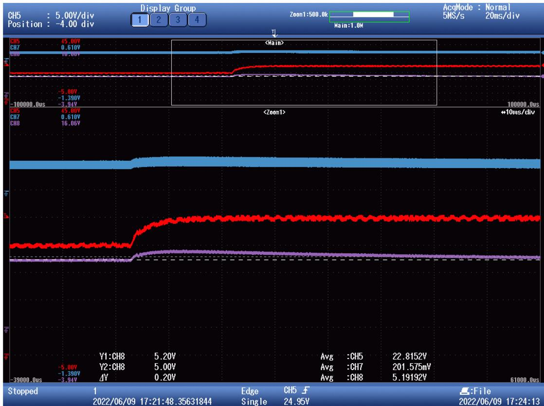
Figura 88. Escalón en la entrada en lazo cerrado (I). Tensión en la salida (morado), tensión en la entrada (rojo) e intensidad en la bobina (azul).
