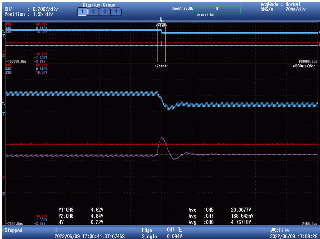
Figura 82. Escalón en la carga con lazo abierto y nueva resistencia shunt (I). Tensión en la salida (morado), tensión en la entrada (rojo) e intensidad en la bobina (azul).
