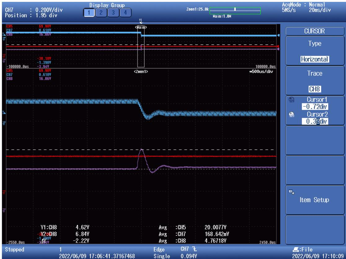
Figura 83. Escalón en la carga con lazo abierto y nueva resistencia shunt (II). Tensión en la salida (morado), tensión en la entrada (rojo) e intensidad en la bobina (azul).
