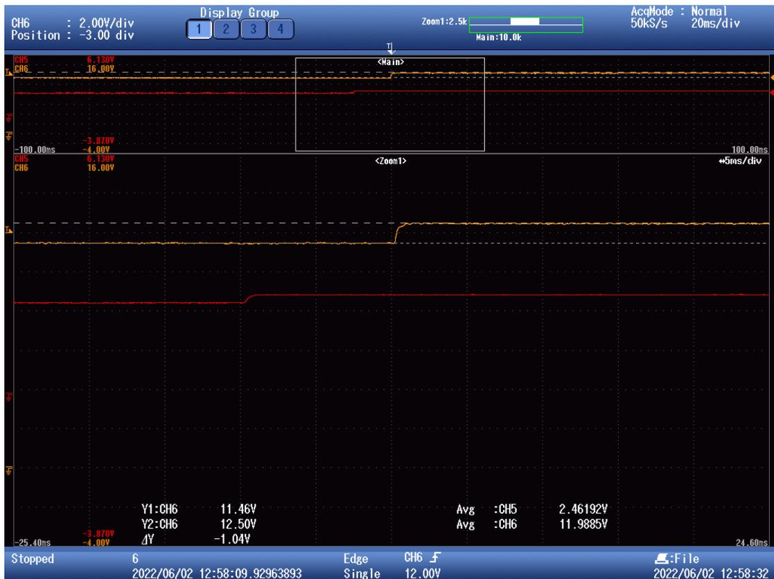
Figura 65. Respuesta transitoria de la tensión de salida (naranja) a un escalón en la referencia (I). Ignorar la traza roja.
