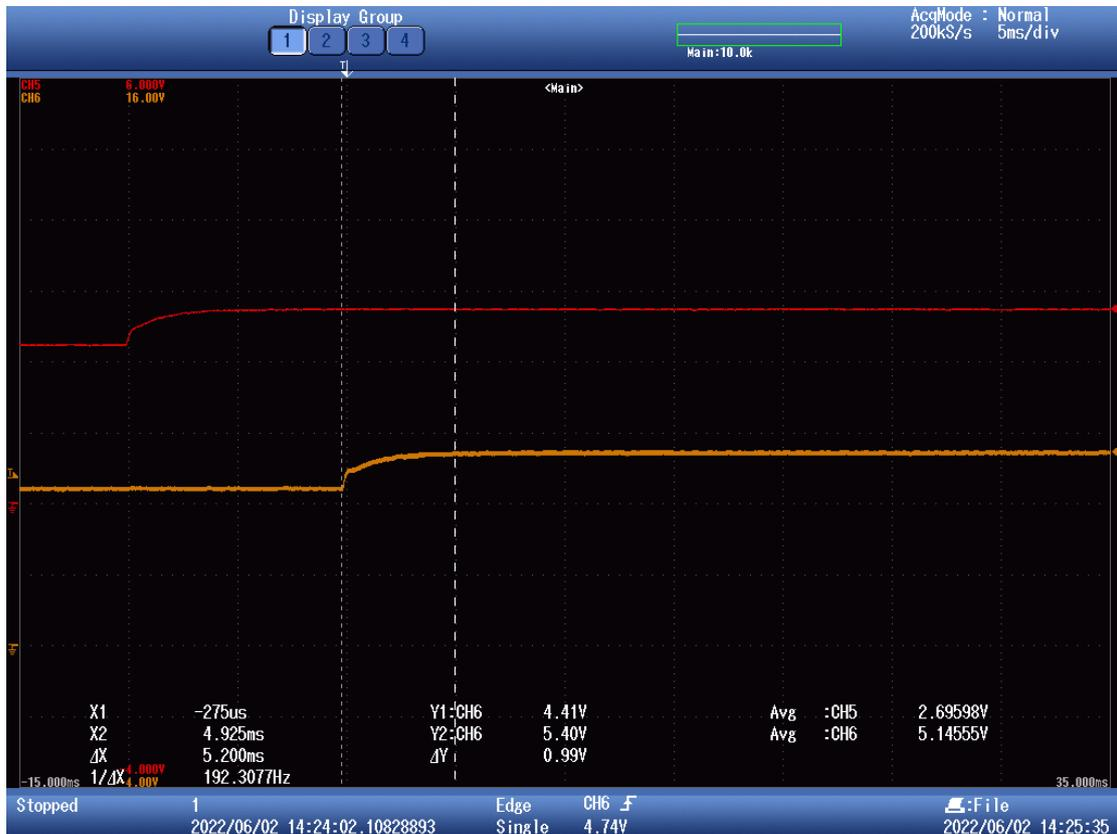
Figura 75. Respuesta de la tensión de salida (naranja) en régimen transitorio a escalones de 1V en la referencia con Voref 5V (III). Ignorar la traza roja.
