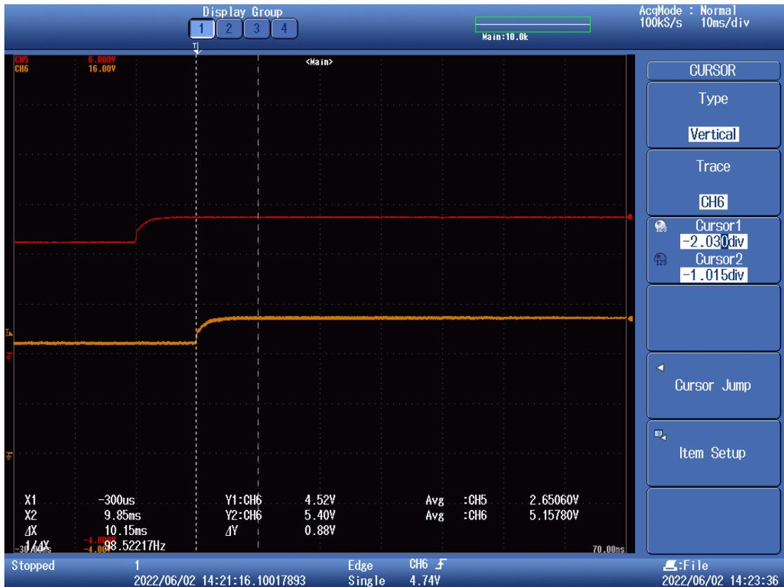
Figura 74. Respuesta de la tensión de salida (naranja) en régimen transitorio a escalones de 1V en la referencia con  $V_{ref}$  5V (II). Ignorar la traza roja.
