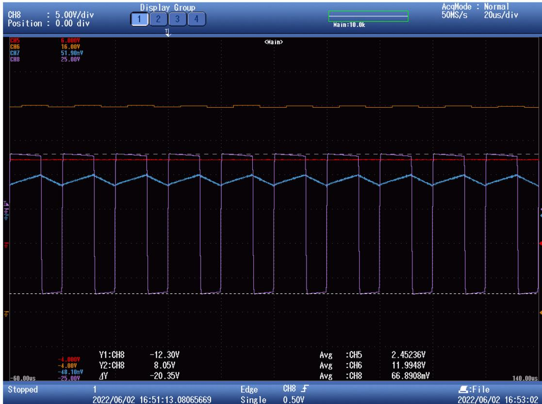
Figura 63. Tensión (morado) e intensidad (azul) de la bobina, tensión en la carga (naranja) y tensión a la entrada del microprocesador (rojo).
