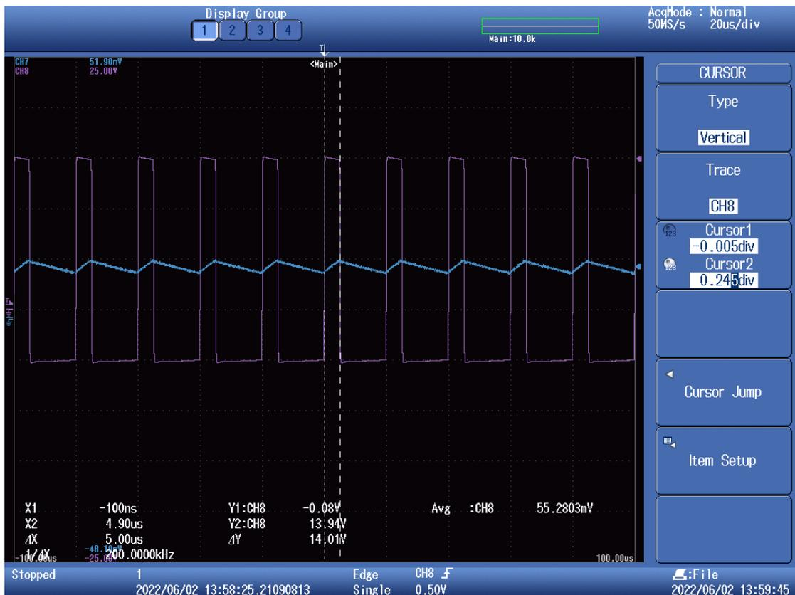
Figura 68. Tensión (morado) e intensidad (azul) en la bobina con tensión de referencia a la salida de 5V (II).
