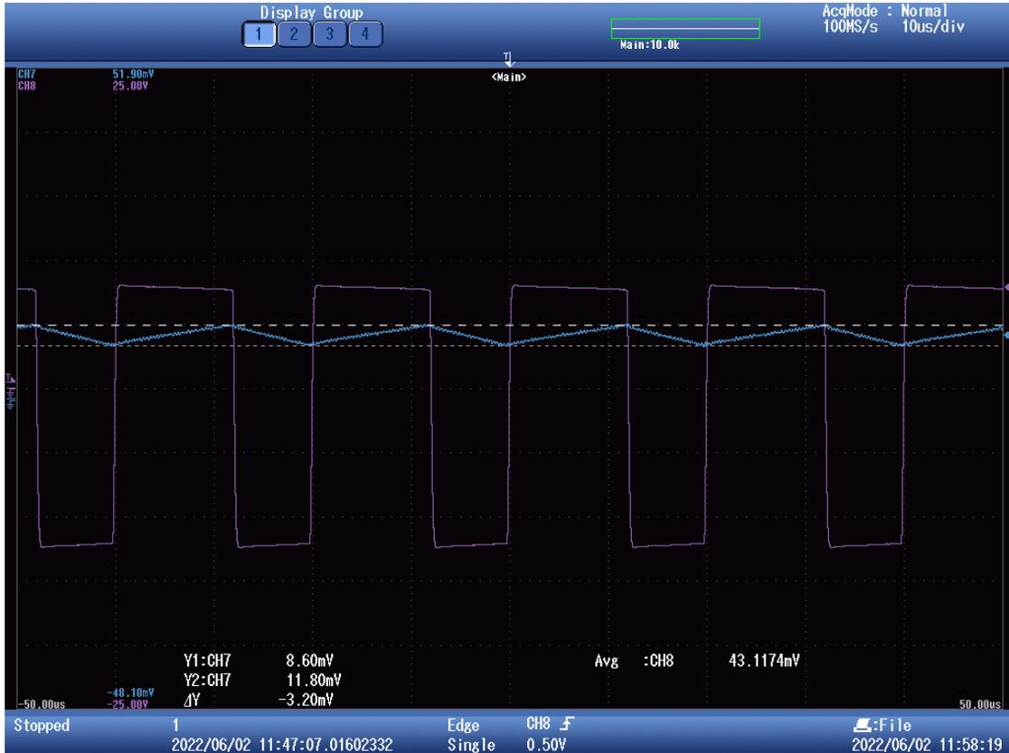
Figura 62. Tensión (morado) e intensidad (azul) en la bobina con Voref 12V. Medida del rizado de la intensidad con los cursores.
