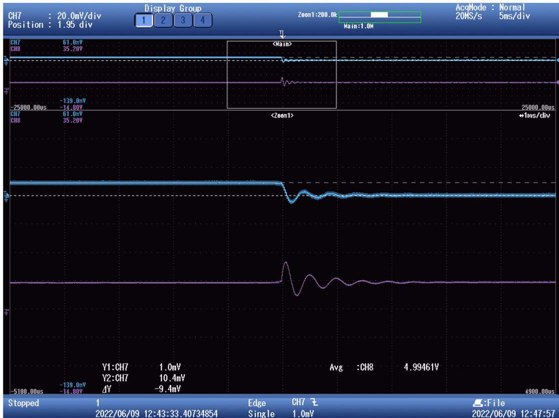
Figura 79. Escalón en la carga con lazo abierto (II). Tensión en la salida (morado) e intensidad en la bobina (azul).
