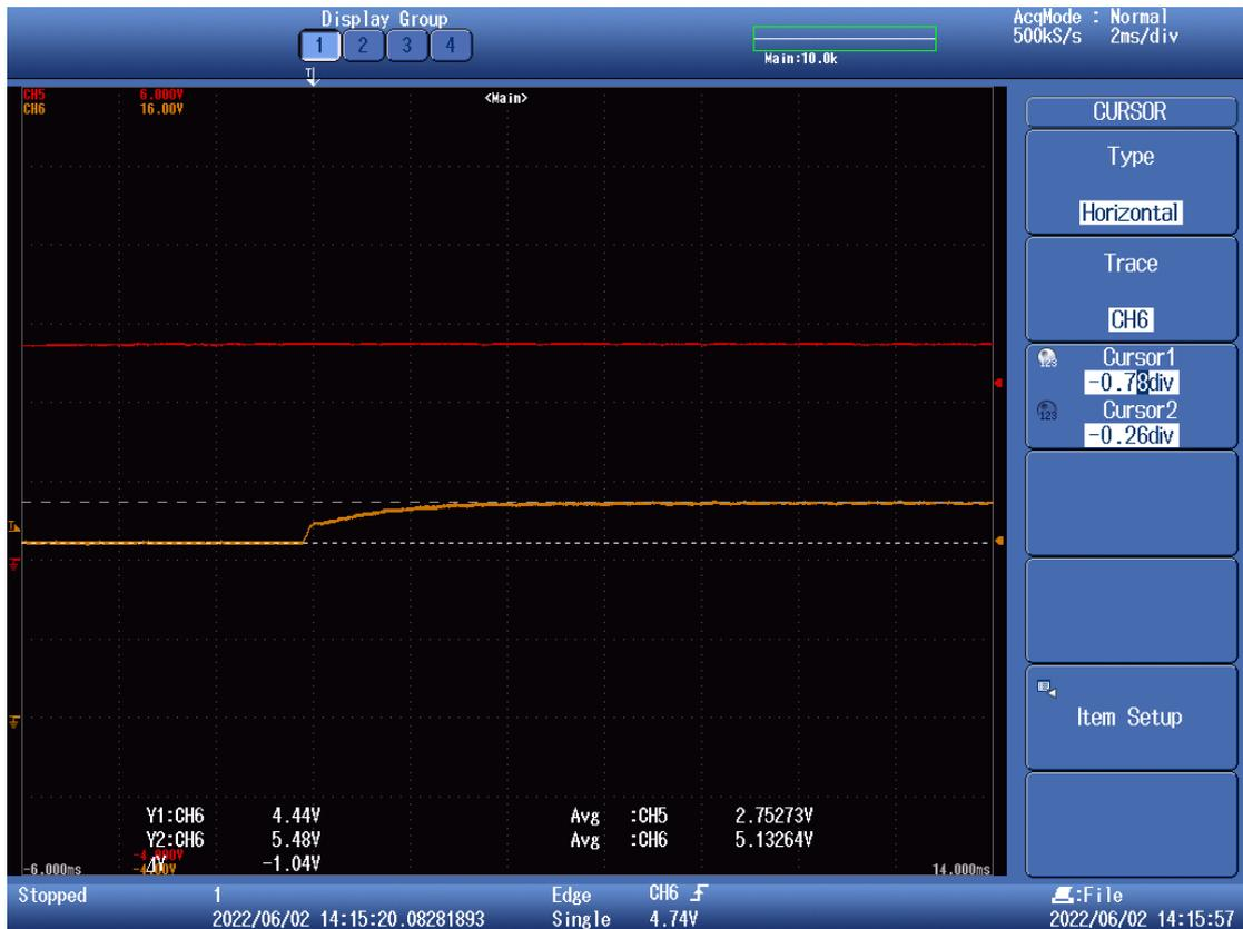
Figura 73. Respuesta de la tensión de salida (naranja) en régimen transitorio a escalones de 1V en la referencia con  $V_{ref} 5V$  (I). Ignorar la traza roja.
