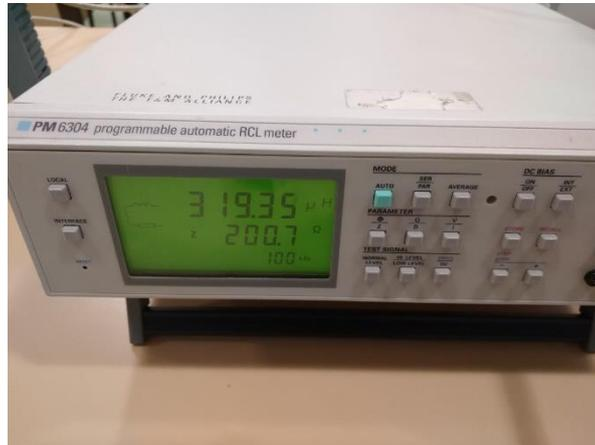
Figura 71. Inductancia de la bobina tomada con un aparato de medida. Foto tomada en el laboratorio de medidas eléctricas de la E.T.S. de Ingeniería (ICAI).
