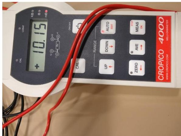
Figura 72. Resistencia de la bobina tomada con un ohmímetro. Medida en miliohmios. Foto tomada en el laboratorio de medidas eléctricas de la E.T.S. de Ingeniería (ICAI).
