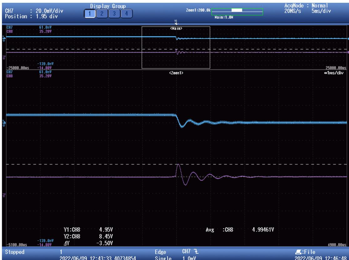
Figura 78. Escalón en la carga con lazo abierto (I). Tensión en la salida (morado) e intensidad en la bobina (azul).
