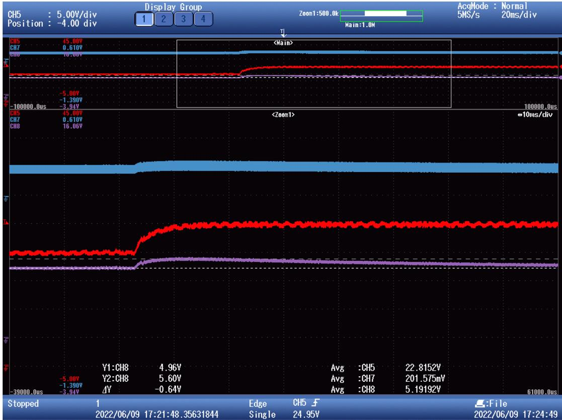
Figura 89. Escalón en la entrada en lazo cerrado (II). Tensión en la salida (morado), tensión en la entrada (rojo) e intensidad en la bobina (azul).
