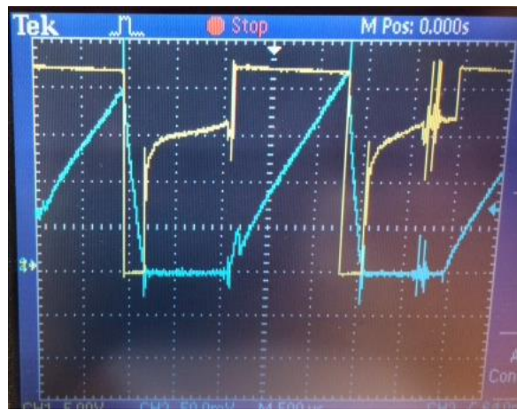
Ilustración 31: Gráficas de la tensión (curva amarilla) y de la corriente (curva azul) del motor en régimen de conducción discontinua, con f=433\text{Hz} y \alpha > 0,5
