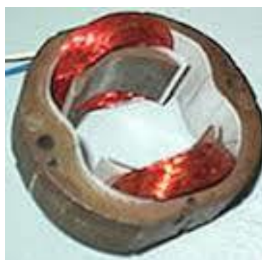
Ilustración 6: Estator de una máquina de corriente continua con imanes permanentes, de dos polos.
