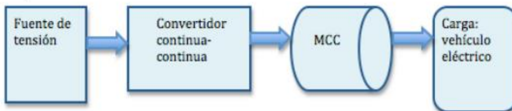
Ilustración 2: Esquema representativo del funcionamiento del patinete
