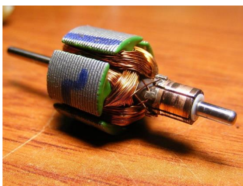
Ilustración 5: Rotor de una pequeña máquina de corriente directa de 12 V, con imanes permanentes, de dos polos, cinco devanados, cinco delgas y dos escobillas.
