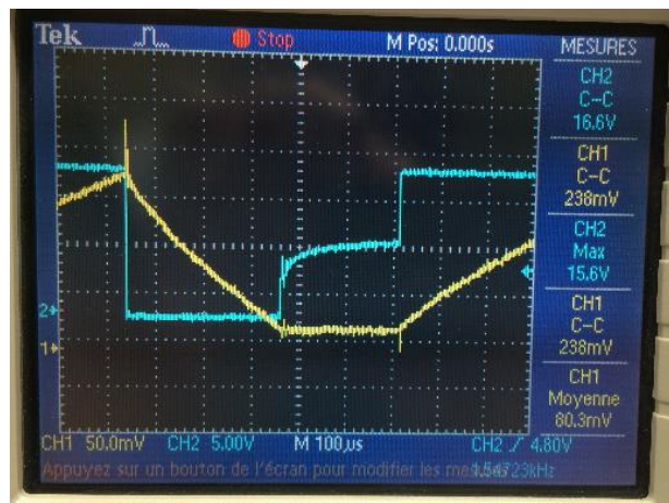
Ilustración 33: Gráficas de la tensión (curva azul) y de la corriente (curva amarilla) del motor en régimen de conducción discontinua, con f=870\text{Hz} y \alpha=0,5
