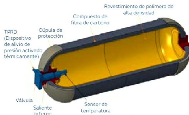
Ilustración 13: esquema de depósito de hidrógeno
