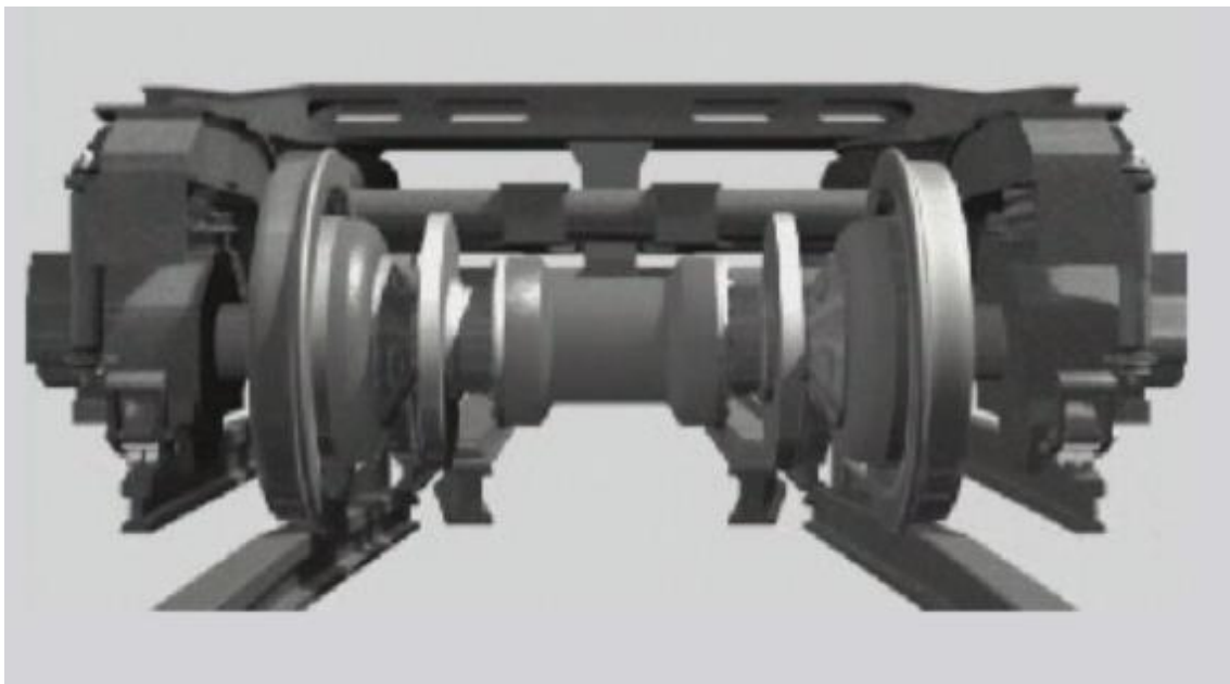
Figura 8. Detalle del Bogie Brava. Fuente: CAF
