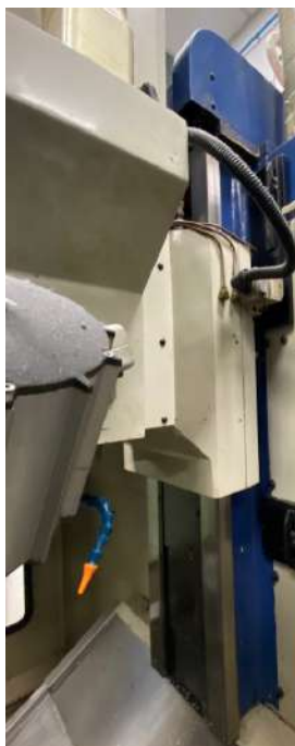
Figura 41. Guías lineales verticales del CMV HV-35.
