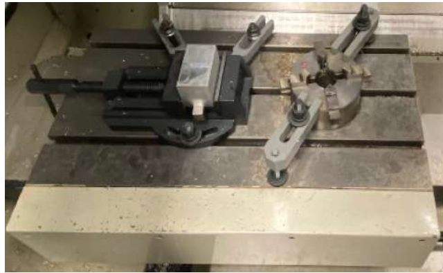
Figura 144. Utillaje de sujeción de la máquina del LSITF del ICAI.
