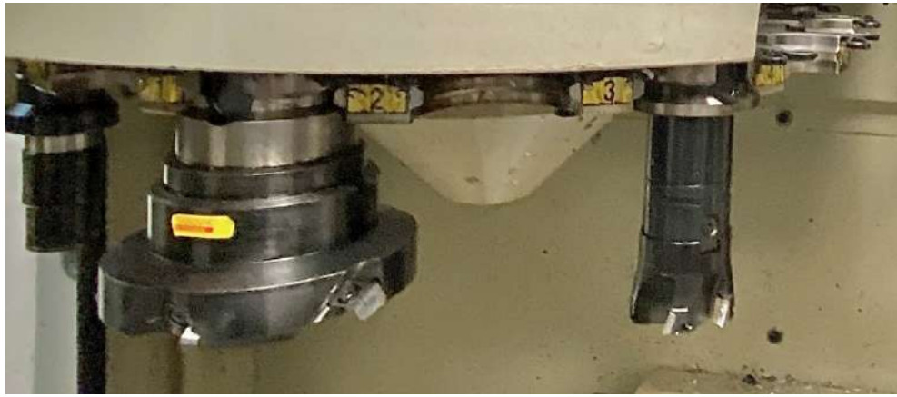
Figura 47. Cambiador automático de herramientas del CMV HV-35.
