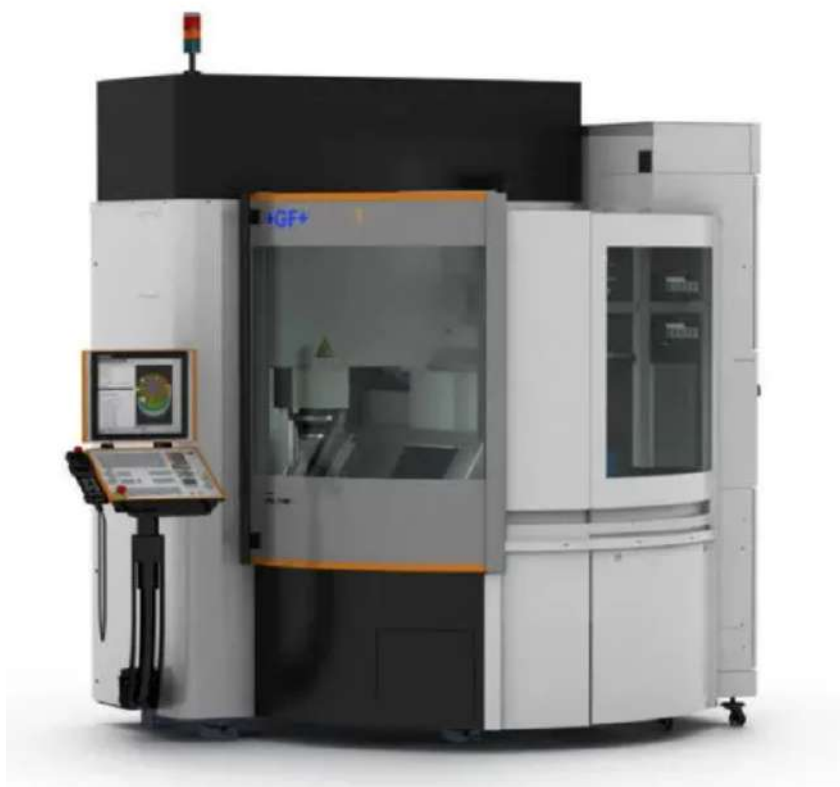
Figura 33. Ejemplo de una fresadora CNC moderna de tres ejes, [DIRE23].
