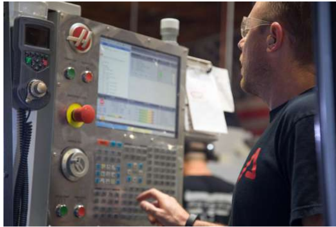
Figura 53. Ejemplo de una pantalla típica de un control CNC Haas , [AIMH23].
