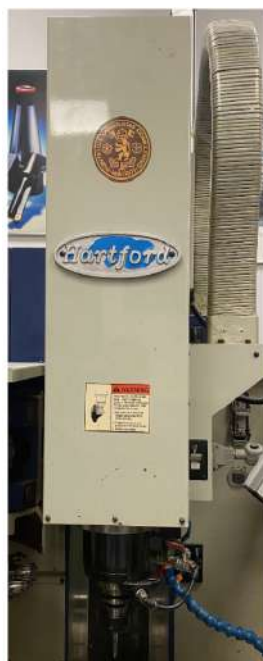
Figura 42. Torre del CMV HV-35.
