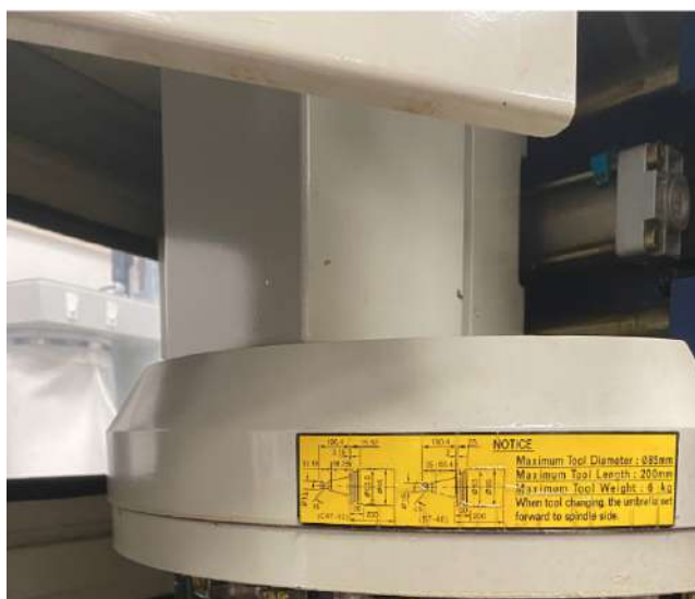
Figura 46. Brazo del cambiador automático de herramientas del CMV HV-35.
