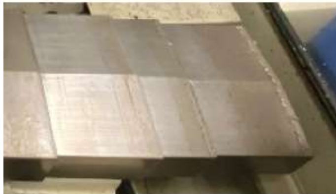
Figura 44. Carro longitudinal del CMV HV-35 .
