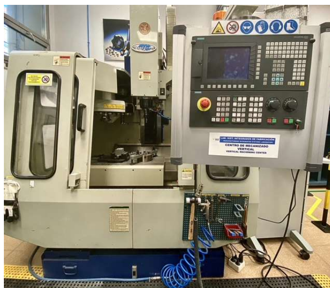
Figura 2. CMV de tres ejes HV-35 del LSITF del ICAI.
