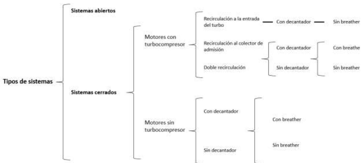
Figura 11 – Clasificación de los sistemas de ventilación de vapores del cárter
