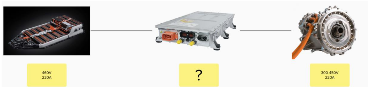
Figura 10: Dimensionamiento de Inversor.
