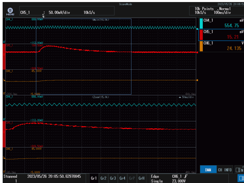
Figura 42: Transitorio de la tensión de salida ante cambios en la entrada de 22 a 24 V. Canales como en la Figura 40.
