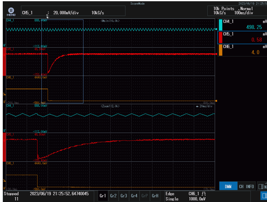
Figura 62: Transitorio en la tensión de salida ante cambios en la entrada de 24V a 22V con control más rápido 'lazoabierto2'. Canales como en la Figura 60.
