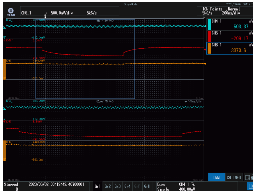
Figura 50: Transitorio en la tensión de salida ante cambio en la referencia de 3,3 V a 3,2 V. Canales como en la Figura 40.
