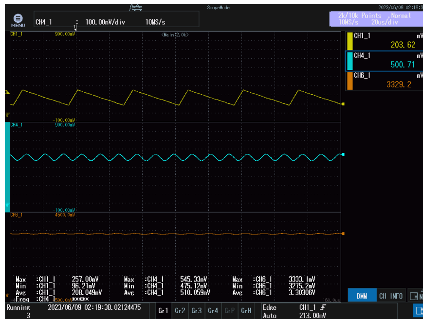
Figura 36: Ensayo en lazo abierto del circuito multifásico. CH1_1 corresponde con la corriente por una de las bobinas, CH4_1 la corriente suma de las tres corrientes (filtrada a 128 kHz) y el CH6_1 la tensión de salida. Las medidas de la derecha son los valores que tenían las distintas medidas en el momento de la captura del osciloscopio.
