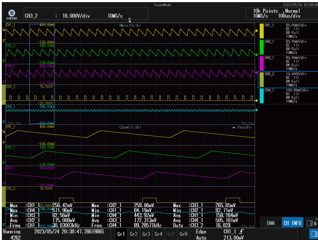
Figura 34: Formas de onda de ensayo lazo abierto punto de trabajo nominal (medidas). Canales como en la Figura 32.
