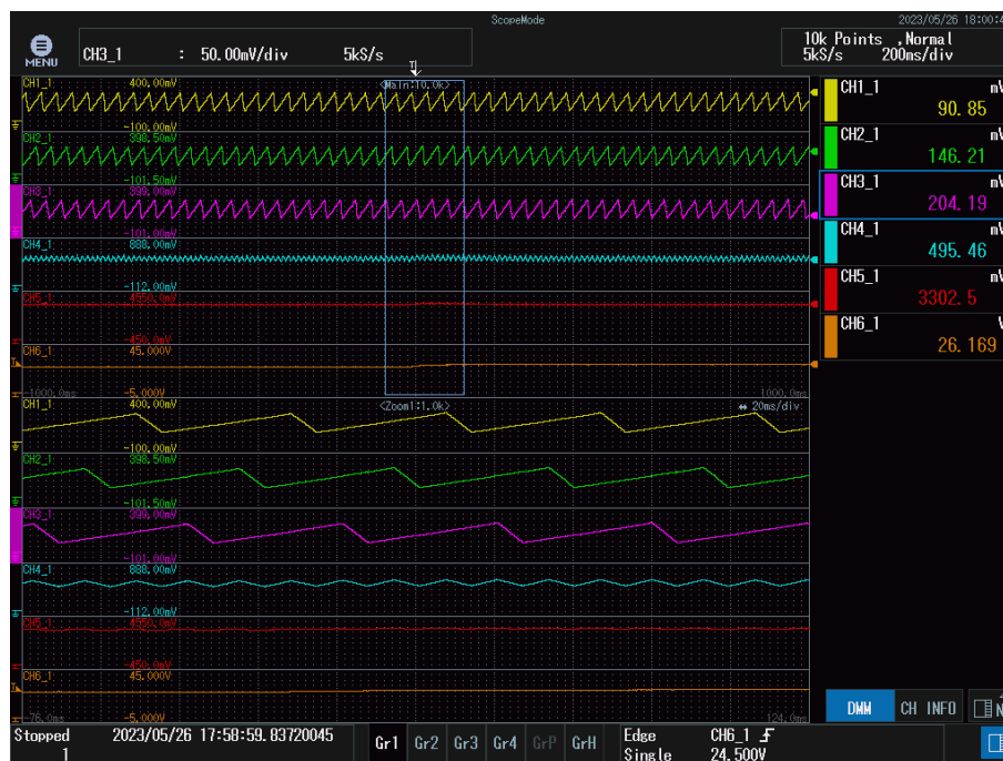
Figura 38: Formas de onda en transitorio ante cambios en la entrada de 24 V a 26 V. El CH1_1, CH2_1, CH3_1 y CH4_1 corresponden respectivamente con las corrientes de la fase A, B, C y la suma de las corrientes de las tres fases, el CH5_1 corresponde con la tensión de salida y, por último, el CH6_1 corresponde con la tensión de entrada.
