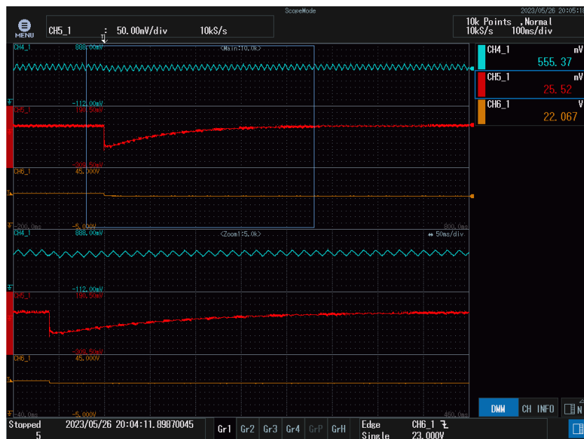
Figura 42: Transitorio de la tensión de salida ante cambios en la entrada de 22 a 24 V. Canales como en la Figura 40.
