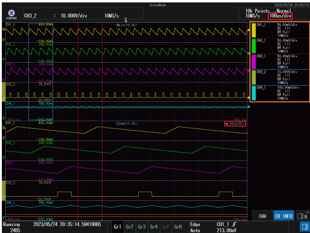
Figura 32: Formas de onda de ensayo lazo abierto punto de trabajo nominal. El CH1_1, CH2_1, CH3_1 se corresponden con la corriente de la bobina de la fase A, B y C respectivamente. El CH4_1 representa la corriente suma de las tres corrientes de las tres bobinas y el CH3_2 los disparos de la fase C.
