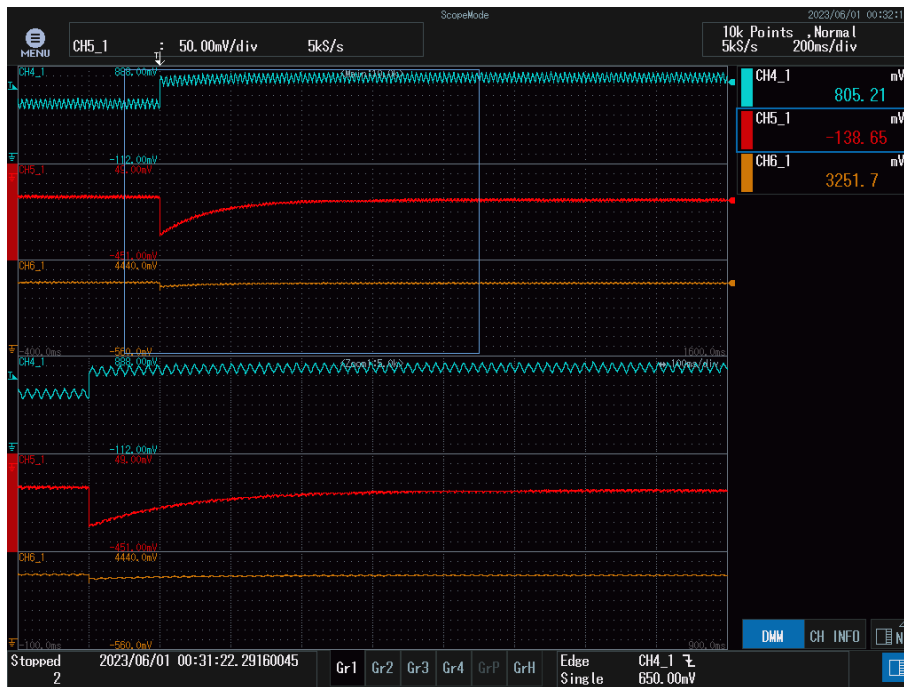
Figura 47: Transitorio en la tensión de salida ante cambio en la corriente de carga de 1 A a 1,5 A. Canales como en la Figura 40.
