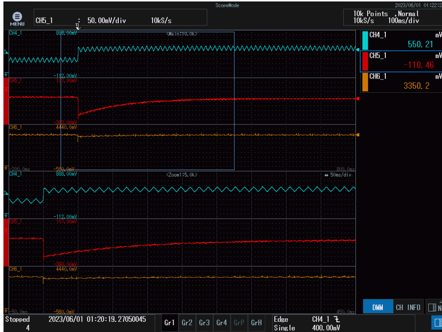
Figura 46: Transitorio en la tensión de salida ante cambio en la corriente de carga de 0,5 A a 1 A. Canales como en la Figura 40.
