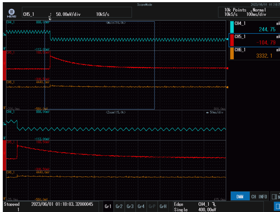
Figura 45: Transitorio en la tensión de salida ante cambio en la corriente de carga de 1 A a 0,5 A. Canales como en la Figura 40.
