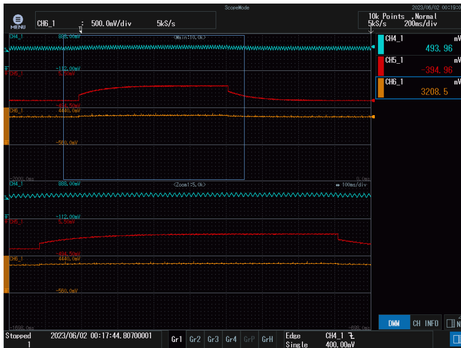
Figura 49: Transitorio en la tensión de salida ante cambio en la referencia de 3,2 V a 3,3 V. Canales como en la Figura 40.
