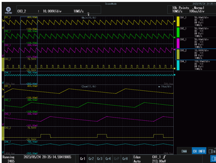
Figura 3: Formas de onda de ensayo lazo abierto punto de trabajo nominal. El CH1_1, CH2_1, CH3_1 se corresponden con la corriente de la bobina de la fase A, B y C respectivamente. El CH4_1 representa la corriente suma de las tres corrientes de las tres bobinas y el CH3_2 los disparos de la fase C.
