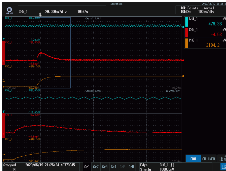
Figura 62: Transitorio en la tensión de salida ante cambios en la entrada de 24V a 22V con control más rápido 'lazoabierto2'. Canales como en la Figura 60.
