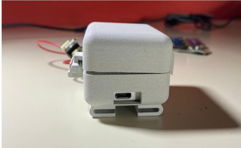
*Ilustración 41: Resultado final de la caja de fuente de alimentación del sistema*
