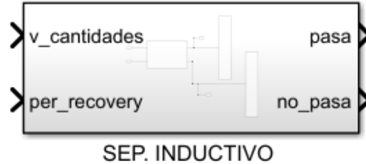
Figura 11. Bloque “Separador inductivo”
