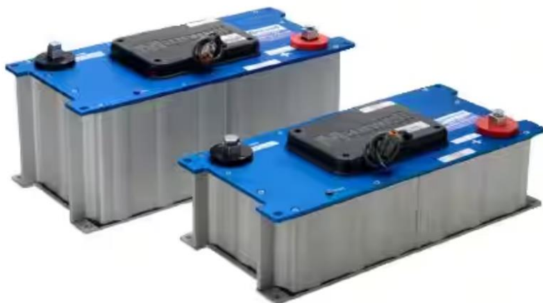
Ilustración 2.25: Fotografías de los supercapacitores de 48 V (BMOD0165 P048 B01) y 75 V (BMOD0094 P075 B02) que ofrece la compañía Maxwell Technologies.
