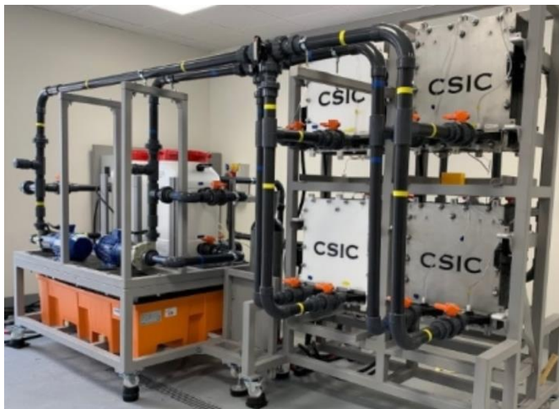
Ilustración 2.15: Batería de flujo de tipo redox de vanadio desarrollada por el CSIC
