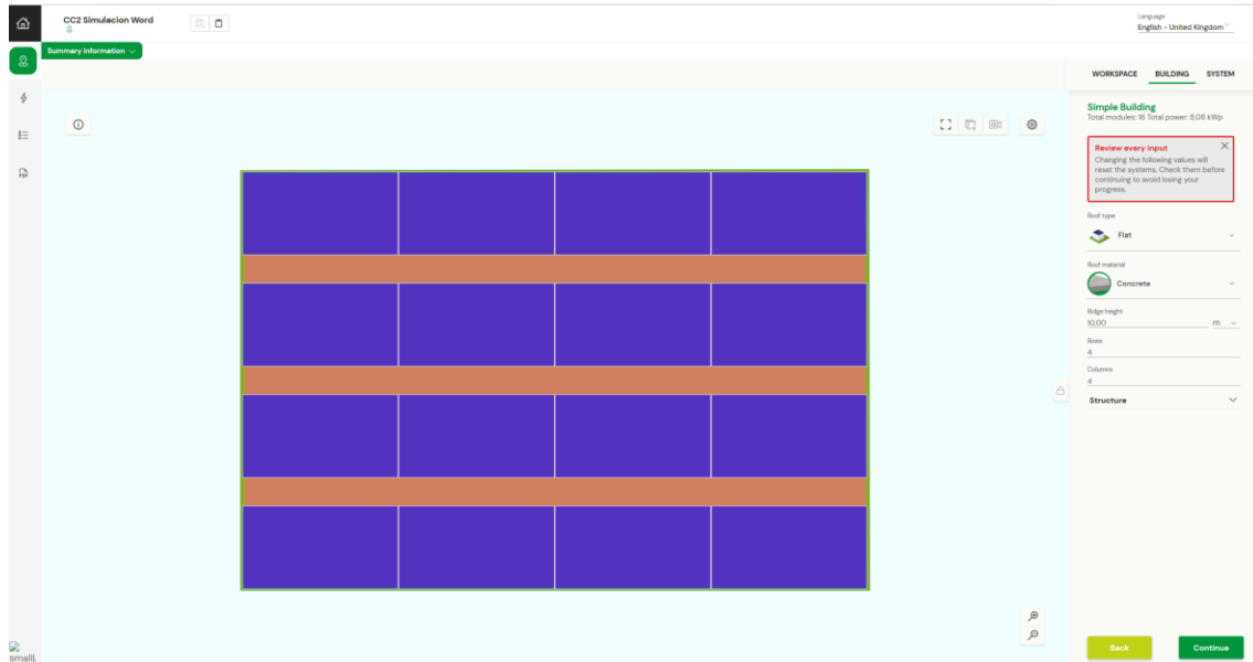
Ilustración 30: Selección del número de paneles necesarios para obtener la potencia de la simulación
