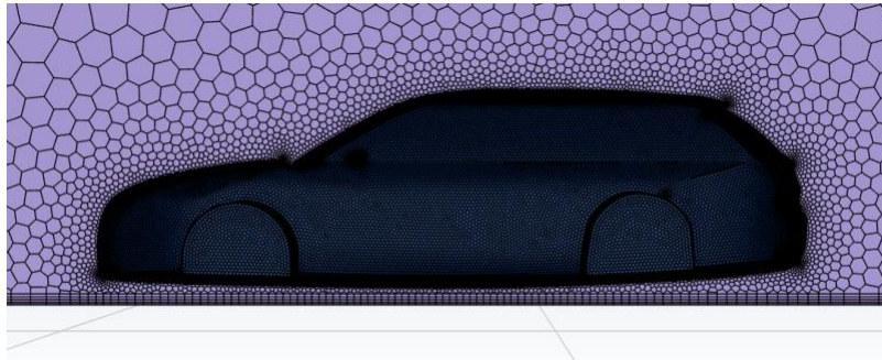
Figura 54 - Malla del vehículo
