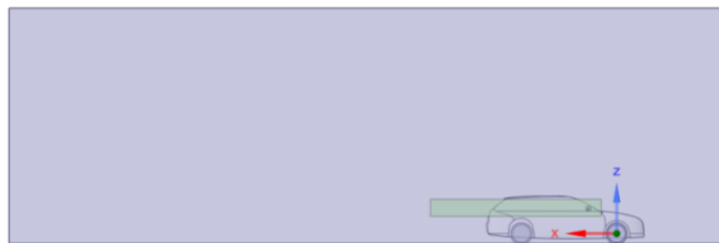
Figura 48 - Dominio computacional, vista isométrica
