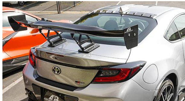
Figura 23 - Generadores de vórtices en un deportivo [22]
