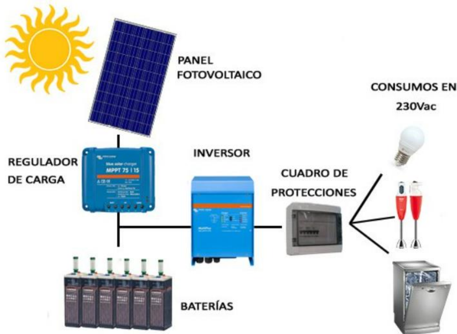
Figura 9: Esquema de una instalación fotovoltaica con baterías 20
