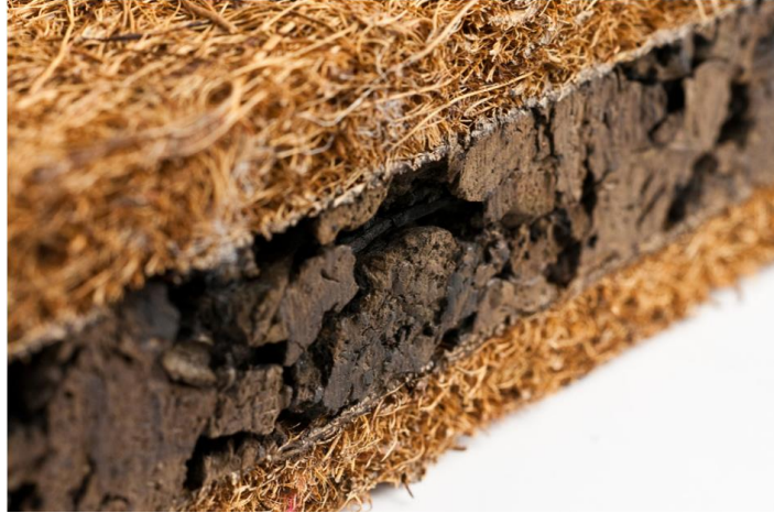
Figura 6: Panel formado por lana de coco y corcho 14
