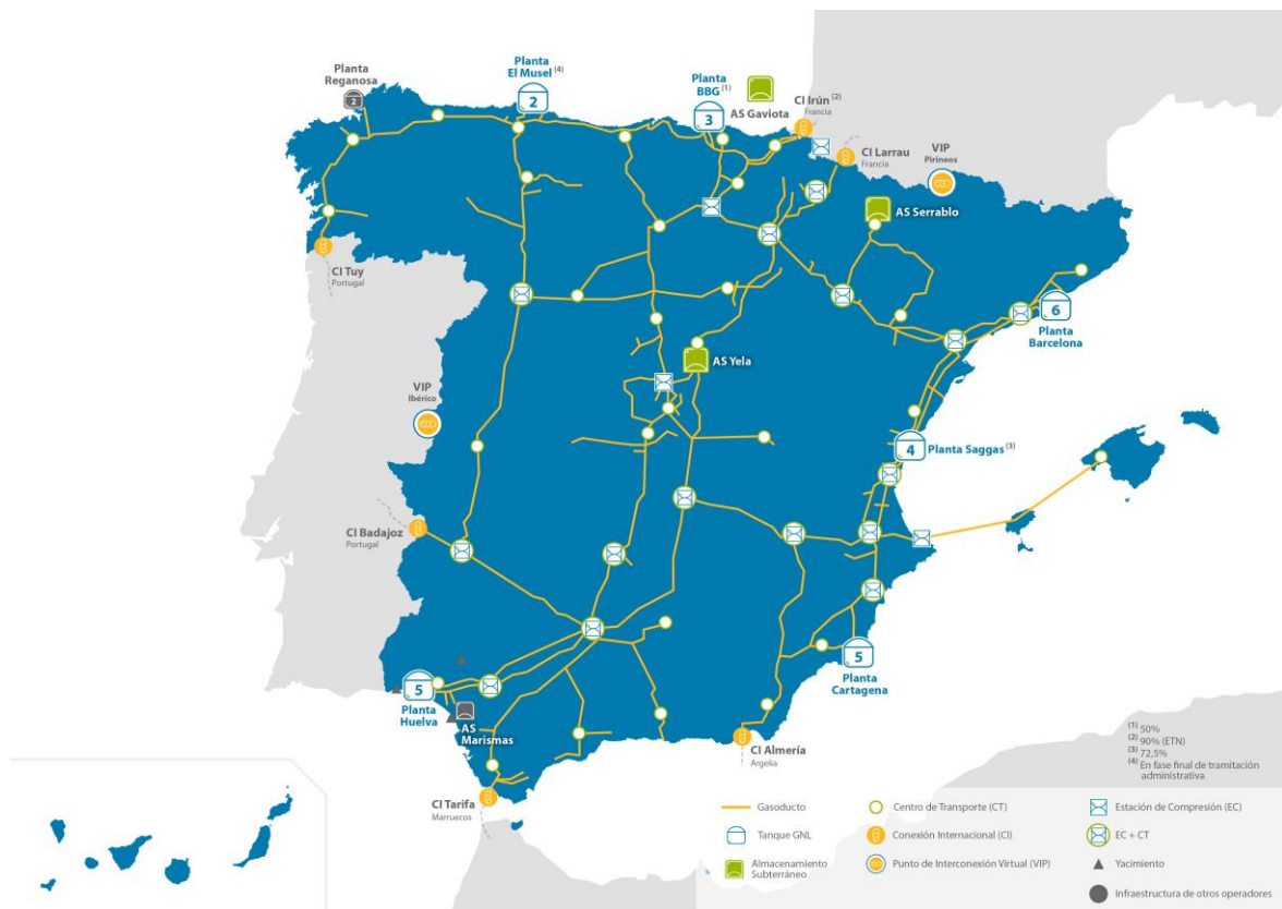
Figura 19. Esquema simplificado de la red gasista española. Fuente: (Enagás, 2022a)
