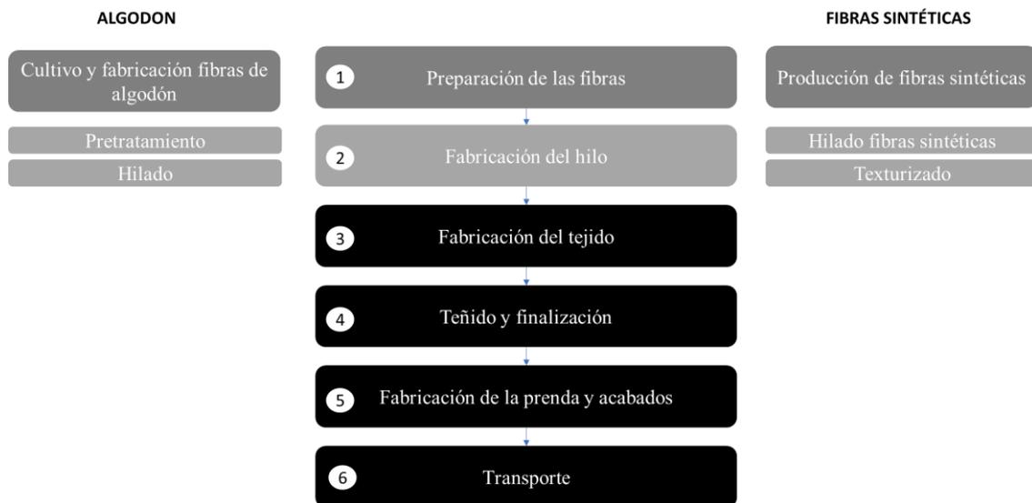
Figura 3: cadena de valor en la industria textil según sean fibras de algodón o sintéticas
