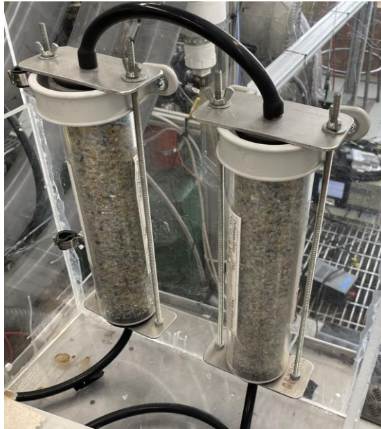
Figura 19: Sistema de secado de la muestra de gases de escape [18]
