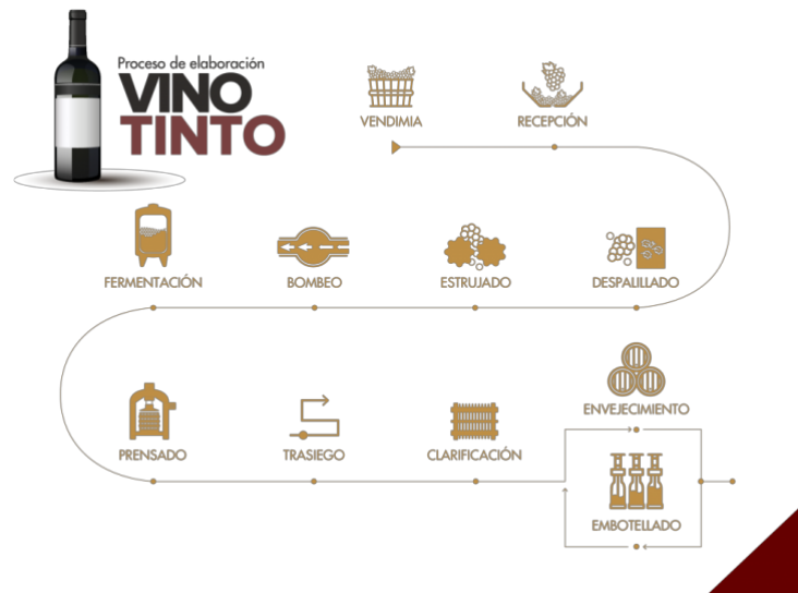
Ilustración 9. Esquema de elaboración del vino tinto.
