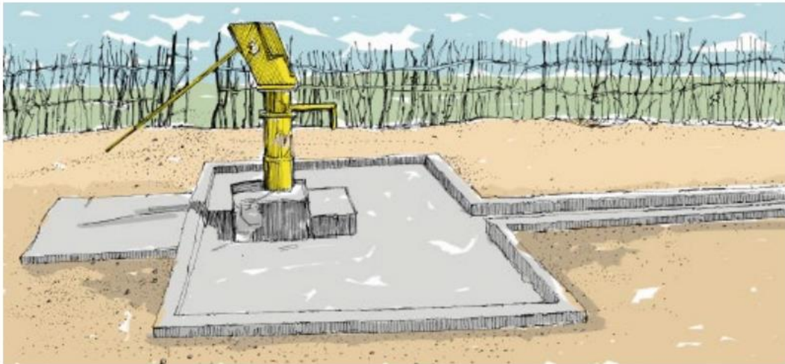
Figura 40. Bomba India Mark con losa de hormigón y desagüe. Fuente: (Skinner B. , 2019)
