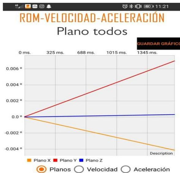
Ilustración 16. Error del dispositivo en 20 segundos.
