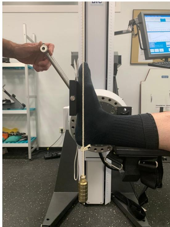
*Ilustración 12. uso de plomada en el dinamómetro. Elaboración propia.*
