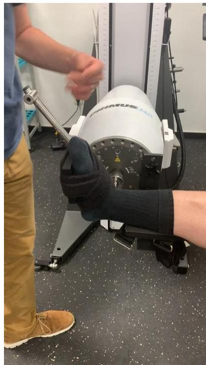
*Ilustración 14. adaptación de la herramienta 701 para la flexión dorsal de tobillo. Elaboración propia.*
