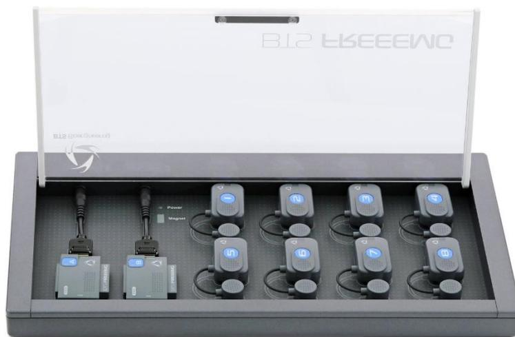
Figura 8 Electromiógrafo BTS FREEMG. Disponible en <https://www.btsbioengineering.com/products/freemg/>
