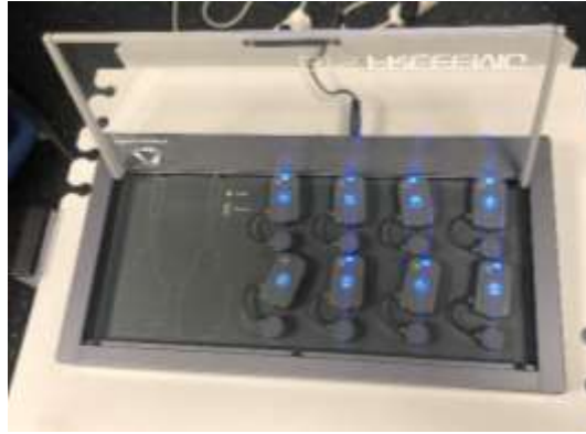
Figura 36. Aparato de Electromiografía con sensores inalámbricos para el análisis dinámico de la actividad muscular, BTS FREEMG, BTS S.p.A, Milano, Italia. Fuente: Elaboración propia.
