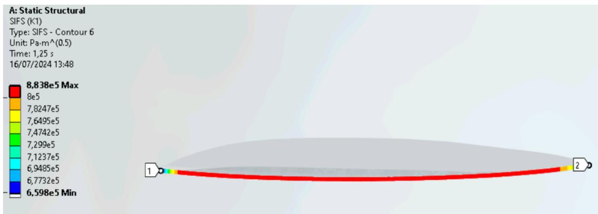
Figura 63. Resultados  $K_1$  Semi-elliptical carga senoidal
