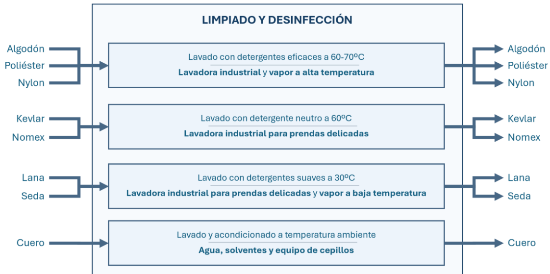
Ilustración 12: Limpieza y desinfección
