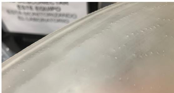
Figura 4.4: Ampliación sobre los defectos observados en la prueba de impresión con la tecnología SLA [Fuente propia]
