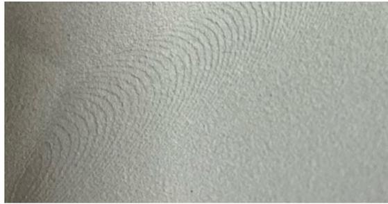
Figura 4.5: Ampliación sobre los defectos observados en la prueba de impresión con la tecnología MJF [Fuente propia]
