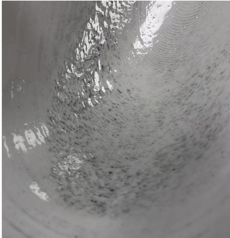
Figura 4.18: Ampliación de la rugosidad obtenida en la zona con warping tras la primera capa de gelcoat [Fuente propia]
