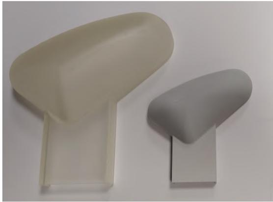
Figura 3.3: Resultado obtenido con las piezas, en MJF (izquierda) y SLA (derecha)[Fuente propia]
