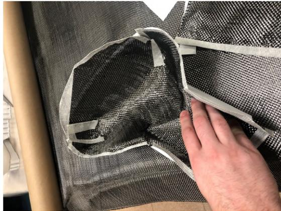
Figura 4.24: Fotografía con la fibra sobre el molde, desde otra perspectiva [Fuente propia]
