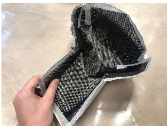
Figura 4.23: Fotografía con la fibra sobre el molde [Fuente propia]
