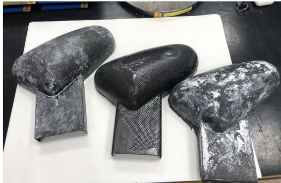
Figura 4.32: Imagen de los 3 moldes obtenidos, por la cara interior [Fuente propia]
