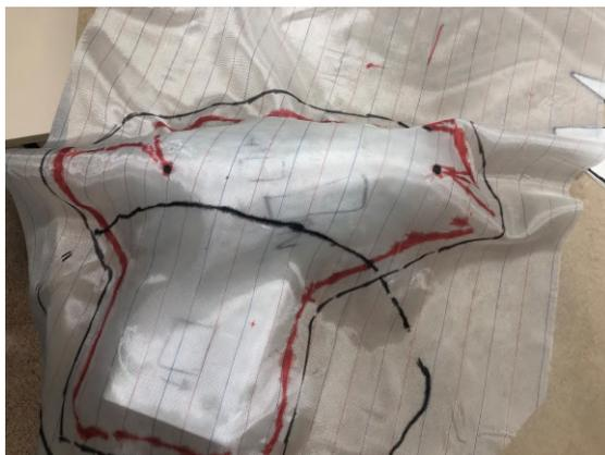
Figura 4.22: Fotografía con la colocación de la tela sobre el molde [Fuente propia]
