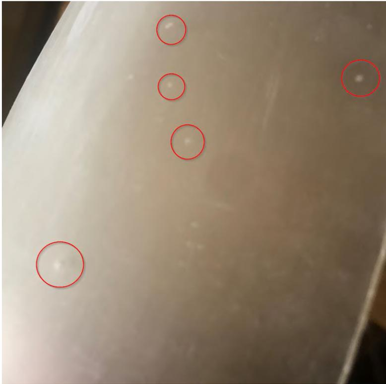
Figura 4.7: Ampliación sobre los defectos observados en la segunda prueba de impresión con la tecnología SLA [Fuente propia]
