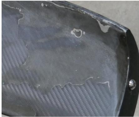
Figura 1.1: Ejemplo Pieza con rebaba [Fuente propia]
