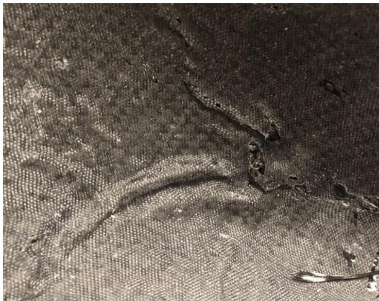
Figura 4.28: Ampliación (2) sobre el segundo defecto en MJF [Fuente propia]
