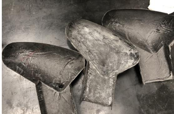
Figura 4.31: Imagen de los 3 moldes obtenidos, por la cara exterior [Fuente propia]
