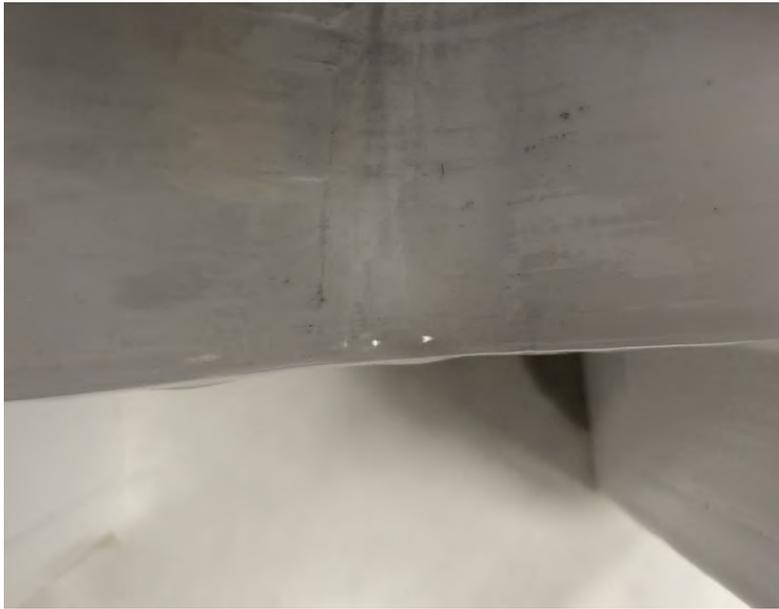
Figura 4.17: Gotas formadas en la parte plana del negativo [Fuente propia]
