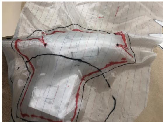
Figura 4.29: Imagen de la tela sobre el molde, con la fibra igual [Fuente propia]
