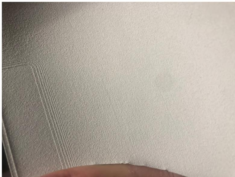
Figura 4.6: Ampliación sobre los defectos observados en la segunda prueba de impresión con la tecnología SLA [Fuente propia]
