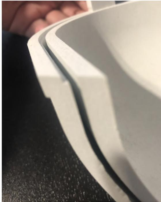
Figura 4.9: Separación de 1,8 mm en la 3<sup>o</sup> prueba [Fuente Propia]
