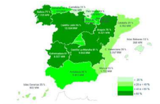
Figura 9. Ratio potencia renovable/ potencia por C.C.A.A. (%) y potencia renovable (MW) (REE, 2024).
