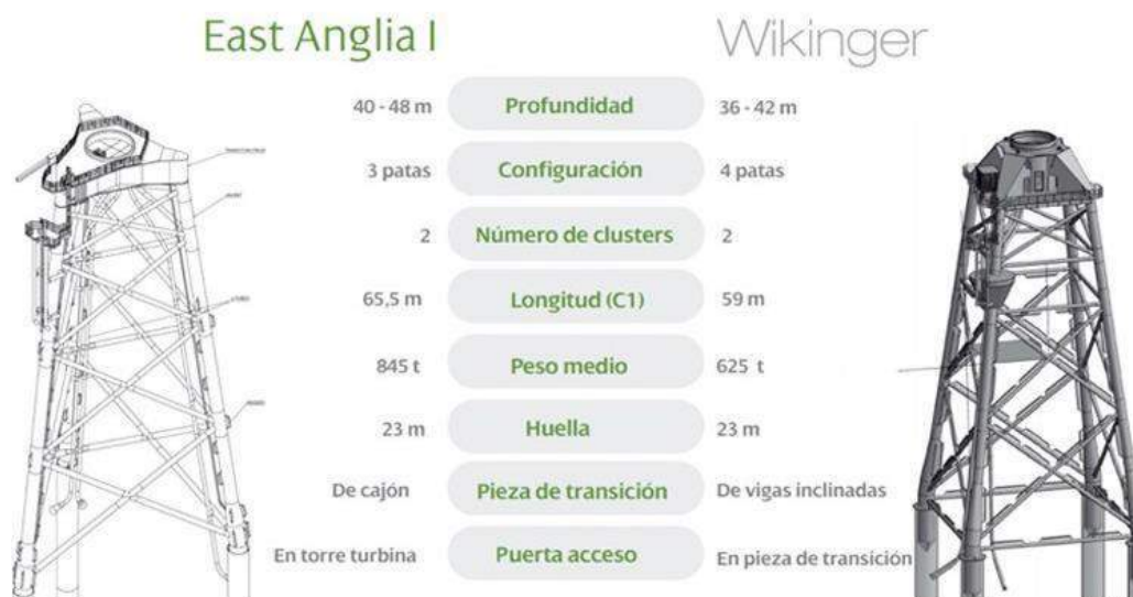
Figura 26. Comparativa de los jackets de East Anglia ONE y Wikinger (Iberdrola, s.f.).
