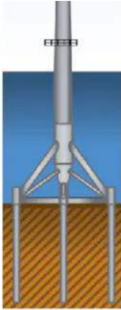
Figura 23. Cimentación trípode (Construction physics).
