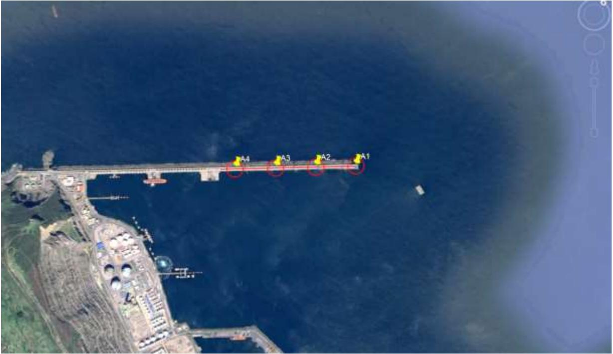
*Figura 9. Disposición final de los aerogeneradores en el dique de Punta Lucero*
