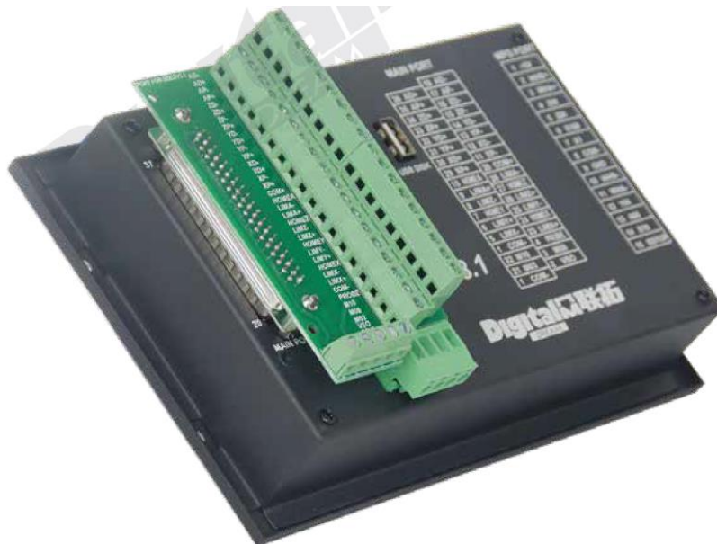
Figura 20: Trasera del controlador con el circuito impreso montado. (21)
