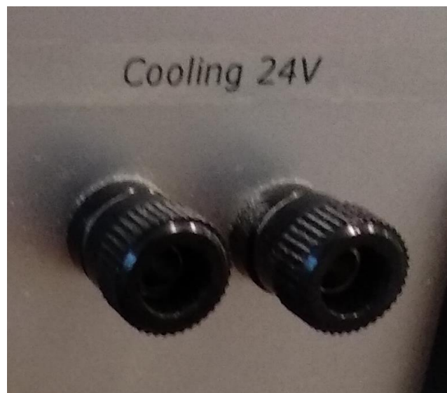
Figura 12: Bornes para refrigeración. (Elaboración propia)
