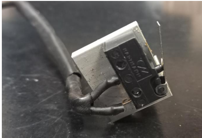
Ilustración 3: Final de carrera original de la máquina. (Elaboración propia).
