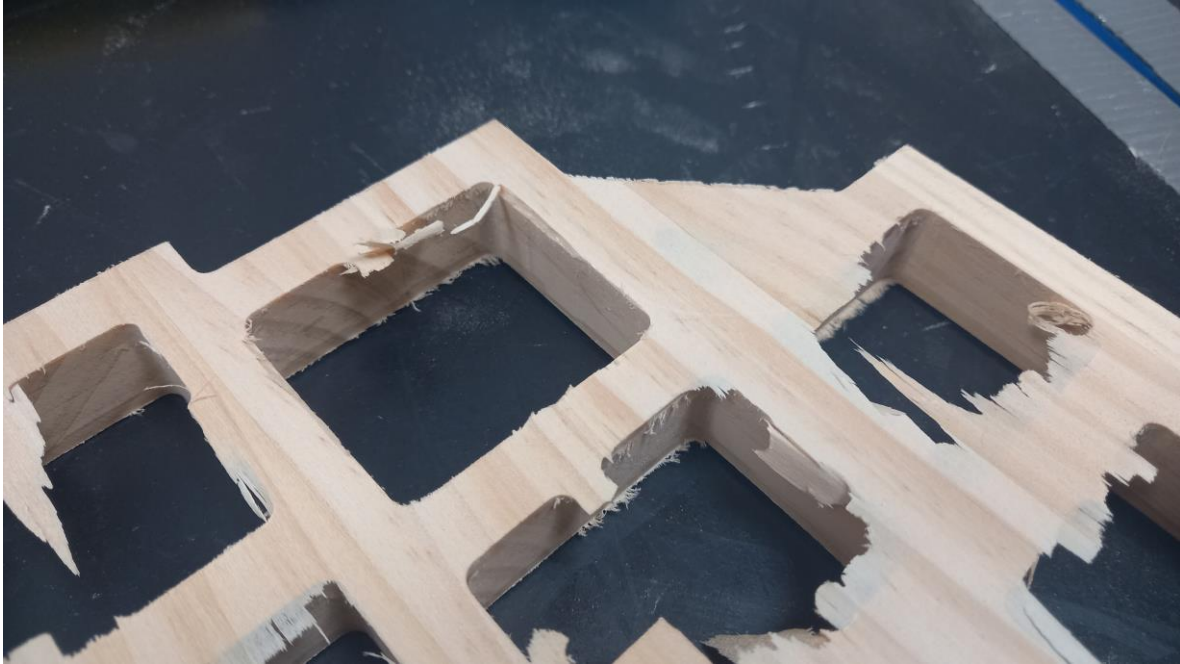
Figura 52: Detalle de la parte inferior de la pieza antes de limpiarla. (Elaboración propia)
