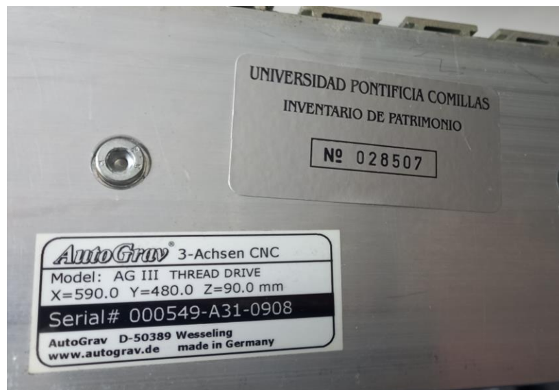
Figura 5: Placa de características de la fresadora AutoGrav. (Elaboración propia)
