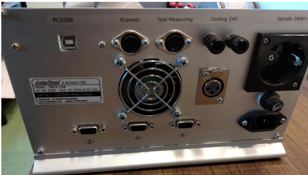
Figura 9: Panel trasero del controlador original. (Elaboración propia)
