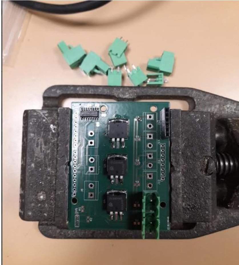
Ilustración 27 – Proceso de soldado de la PCB
