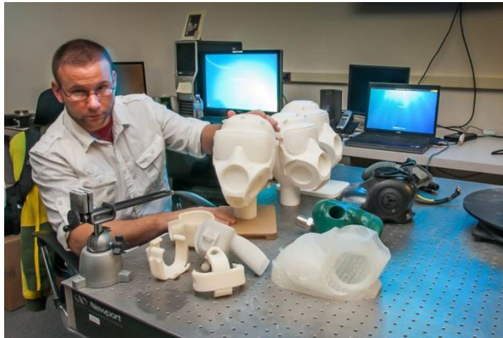
Ilustración 11. Máscaras fabricadas mediante impresión 3D en la armada norteamericana (Army Researchers Use Cutting Edge 3D Printers, s. f.)
