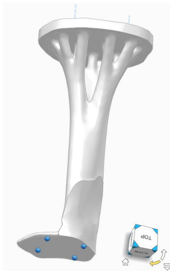
Ilustración 38. Modelo tibia optimizado con error (fuente propia)
