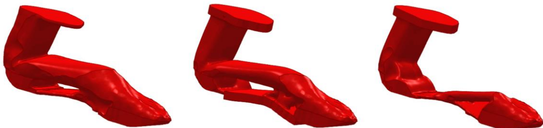
Ilustración 46. Modelos pie optimizados; reducción de masa de un 30% (a), 50% (b) y 60% (c) (fuente propia)
