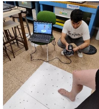
Ilustración 25. Escaneo miembro sin amputar posición vertical mediante Go!SCAN 50 (Fuente propia)
