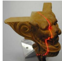
Ilustración 14. Funcionamiento escaneo mediante láser (Castillo Castillo, 2018)
