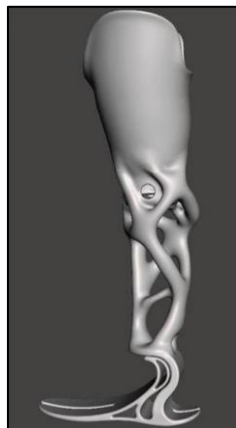
Ilustración 10. Vista lateral del diseño monocoque de Limber (Luca Gabriele De Vivo Nicoloso et al., 2021)
