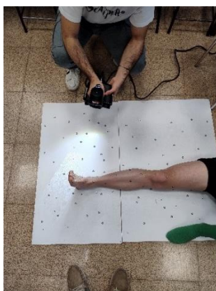
Ilustración 27. Escaneo miembro sin amputar posición horizontal mediante Go!SCAN 50 (Fuente propia)
