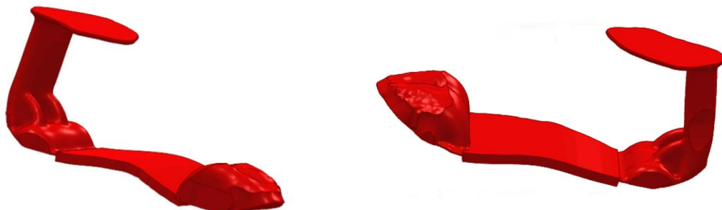
Ilustración 47. Modelo pie optimizado final; reducción de masa de un 70% (fuente propia)
