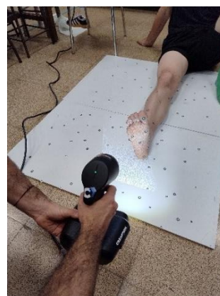
Ilustración 27. Escaneo miembro sin amputar posición horizontal mediante Go!SCAN 50 (Fuente propia)
