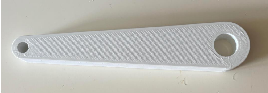
Ilustración 94. Impresión del prototipo de la biela original
