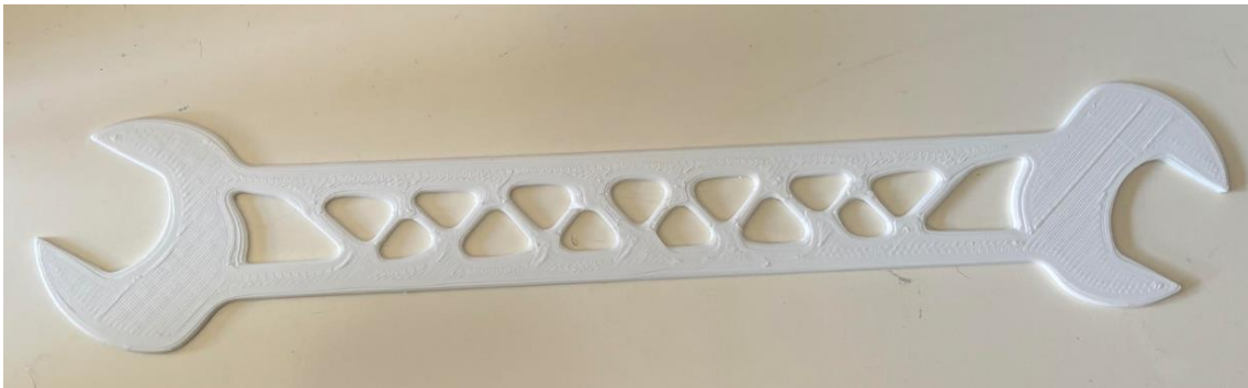
Ilustración 91. Impresión del prototipo de la llave fija optimizada
