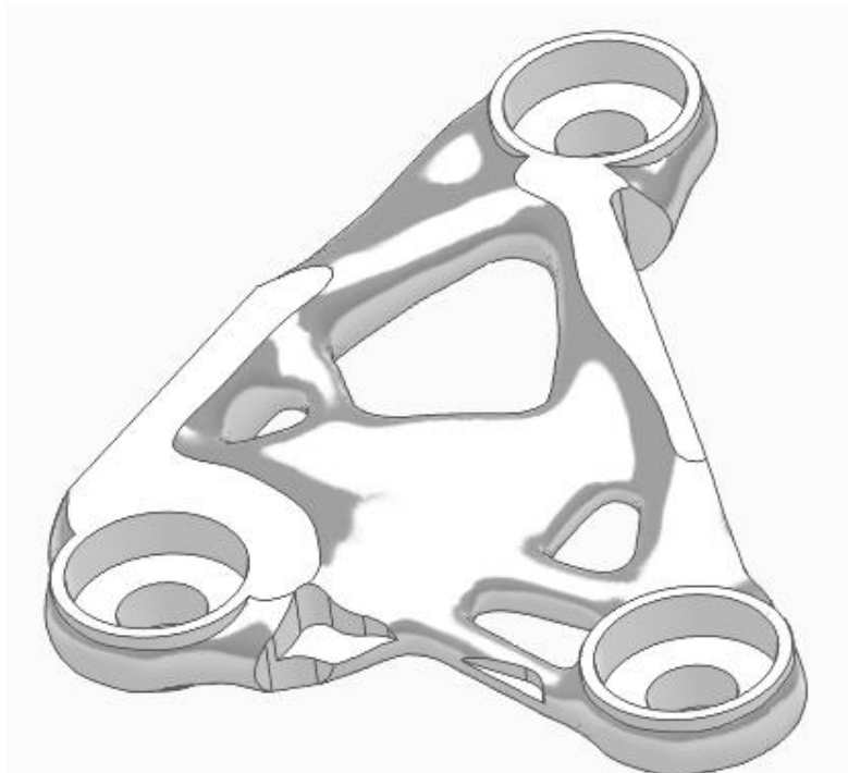
Ilustración 54. Soporte de la bomba con un 50% de reducción de masa
