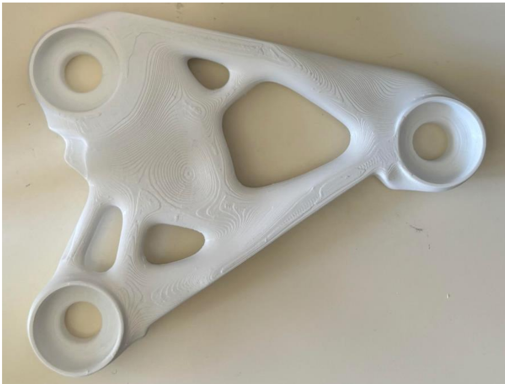
Ilustración 93. Impresión del prototipo del soporte optimizado
