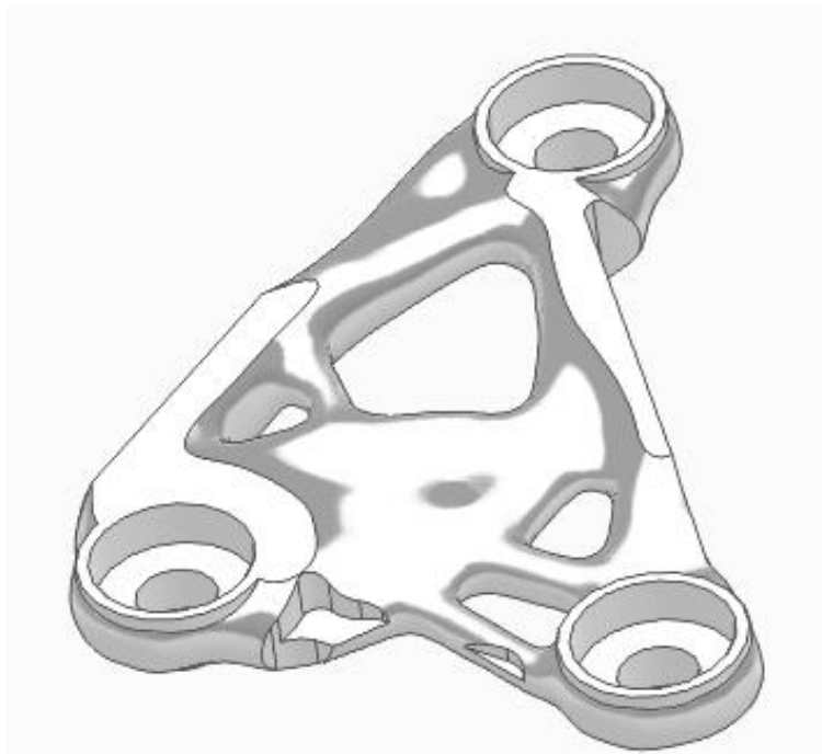
Ilustración 58. Soporte de la bomba con un 51% de reducción de masa
