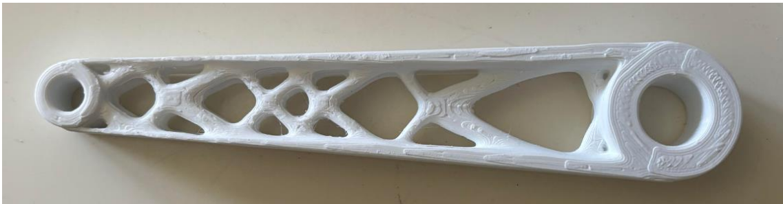
Ilustración 95. Impresión del prototipo de la biela optimizada
