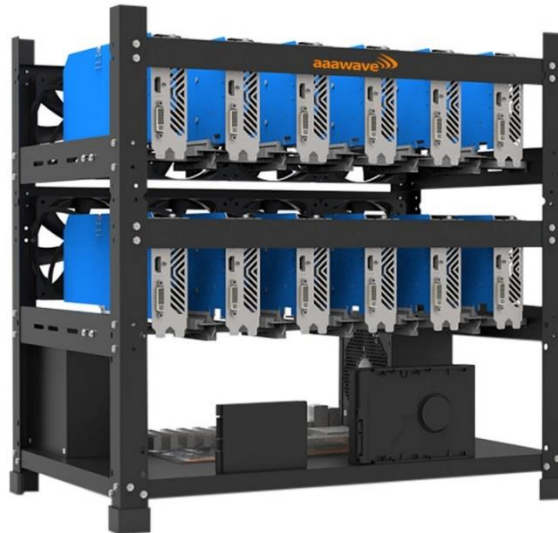
Ilustración 3: Rig de minado de 12 GPU's.
