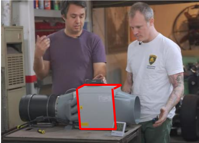
Ilustración 5: Estación Bitcoin con accesorios de reducción de ruido instalados.
