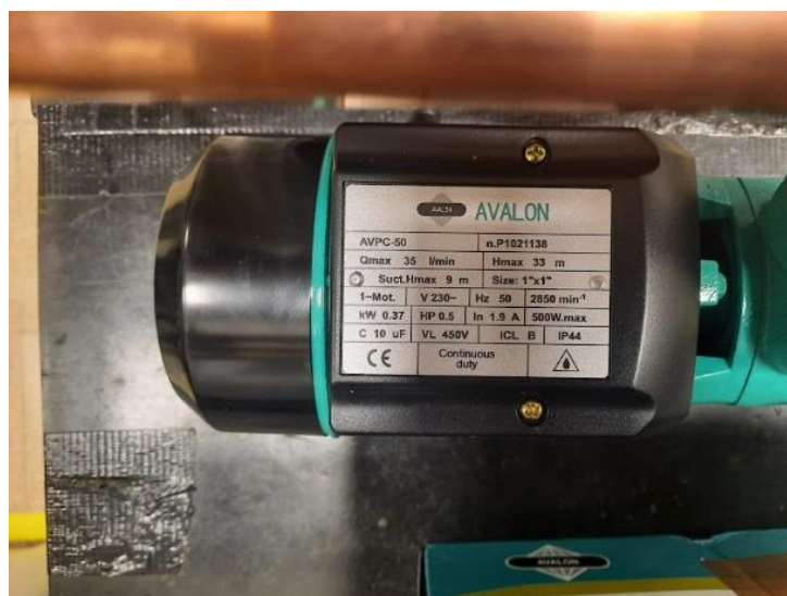
Ilustración 27: Características técnica bomba.
