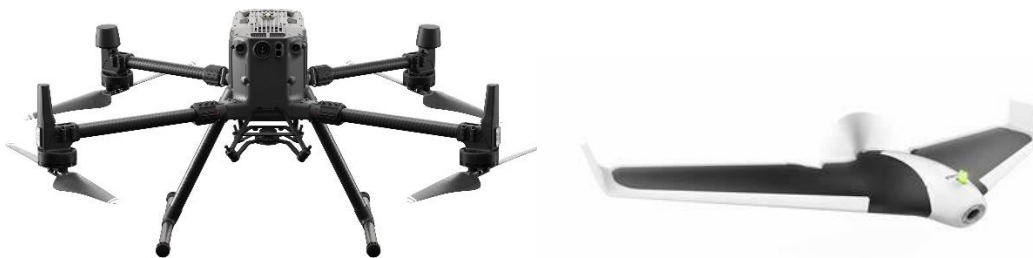
Imagen 2. Dron multirrotor (DJI) frente a dron de ala fija (Parrot)
