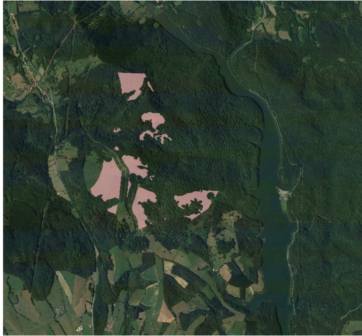
Ilustración 4. Ortofotografías de la zona de estudio en la que se representa en color rosa la zona óptima obtenida tras realizar un análisis multicriterio pormenorizado (ENV-GIS).
