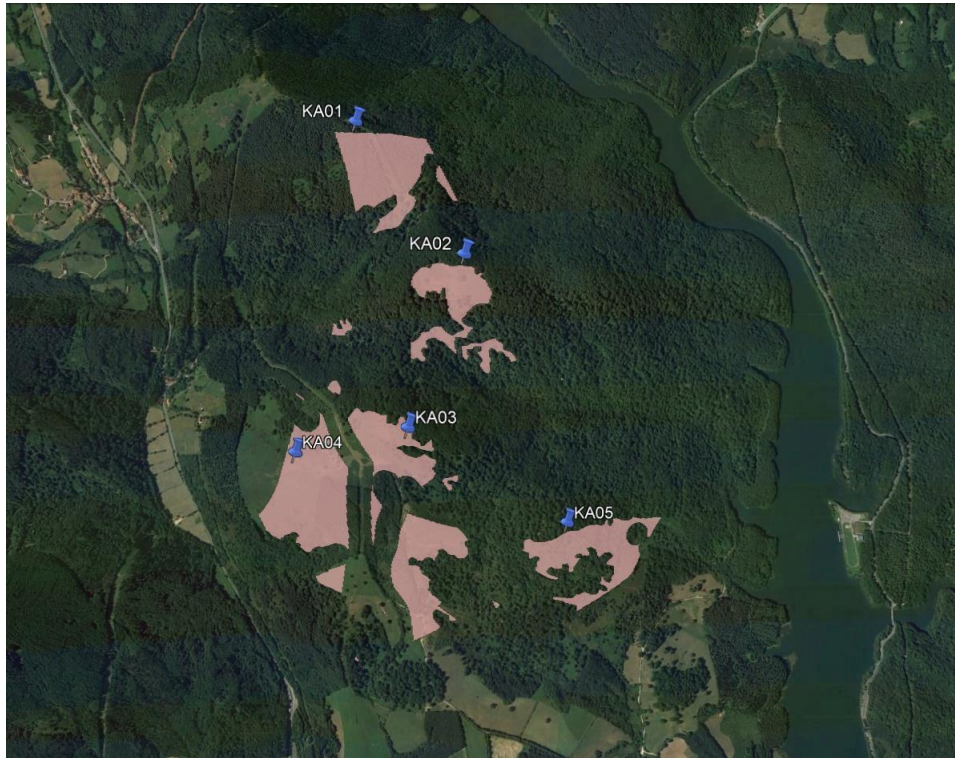
Ilustración 5. Alternativa elegida de layout del Parque Eólico. En rosa se muestra la zona óptima
