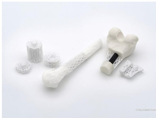
Ilustración 2: Impresión 3D de scaffolds [2]
