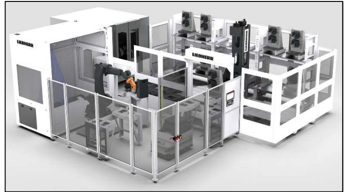
Figura 1. Diseño conceptual de una célula flexible [1]
