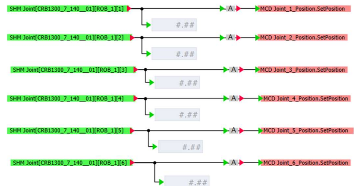
Figura 26. Gráfico de conexiones de posiciones de articulaciones
