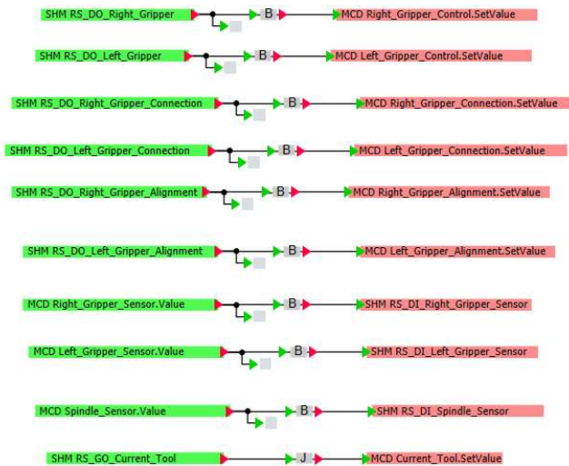
Figura 27. Gráfico de señales I/O entre RobotStudio y NX
