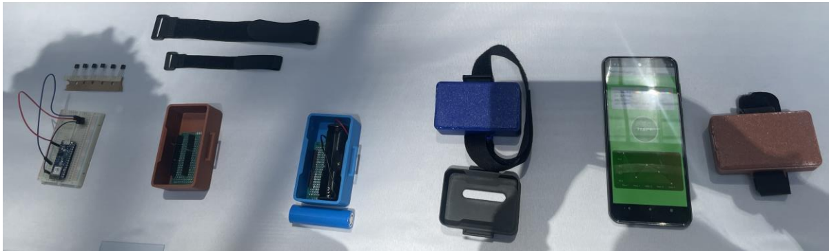
Figura 34 – Proceso de iteraciones carcasa 3D
