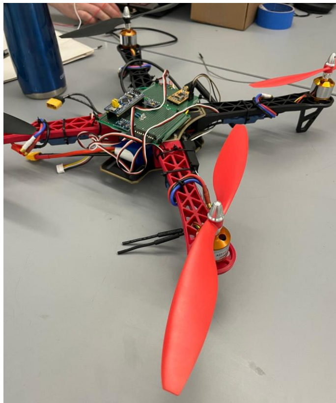
Figura 14- Hélices de plástico reforzado con nylon
