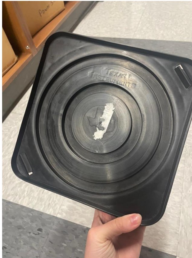
Figura 1- Potador de materiales semiconductores proporcionado por Texas Instruments
