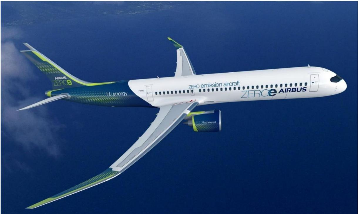
*Ilustración 23: Prototipo de avión alimentada por H2 como combustible de Airbus*
