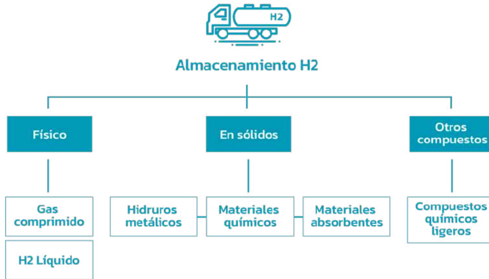
Figura 12: Tipos de almacenamiento de hidrógeno. Fuente: Asociación Peruana del Hidrógeno, 2022.
