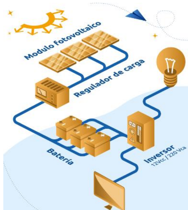
Ilustración 4: Elementos de un sistema fotovoltaico (ENSE , 2021)
