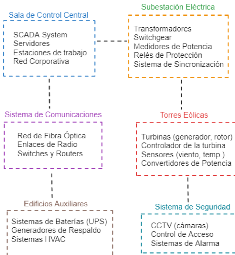
Ilustración 18: Diseño simplificado arquitectura de control del sistema eólico
