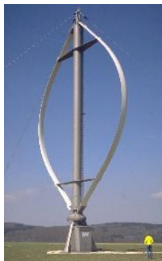
Figura 11: Aerogenerador de eje vertical con rotor Darrieus
