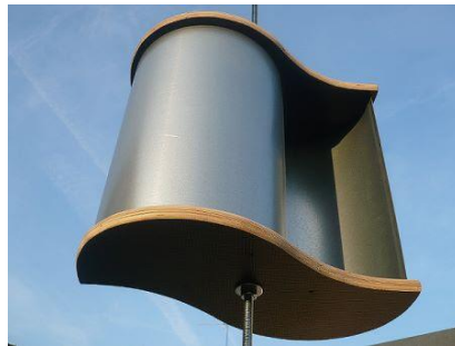
Figura 10: Aerogenerador de eje vertical con rotor Savonius
