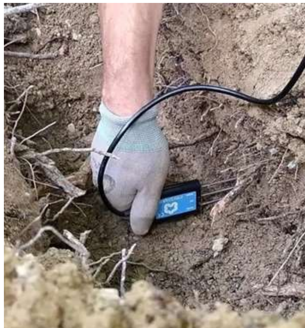
Ilustración 13: Colocación del sensor en la explotación Fuente: FuenteJardín, 2024
