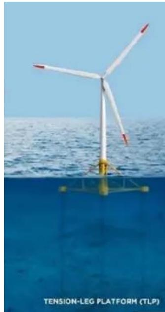
*Ilustración 11: Estructura TLP*
