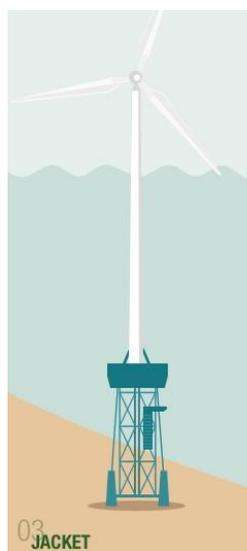
*Ilustración 6: Estructura tipo Jacket*
