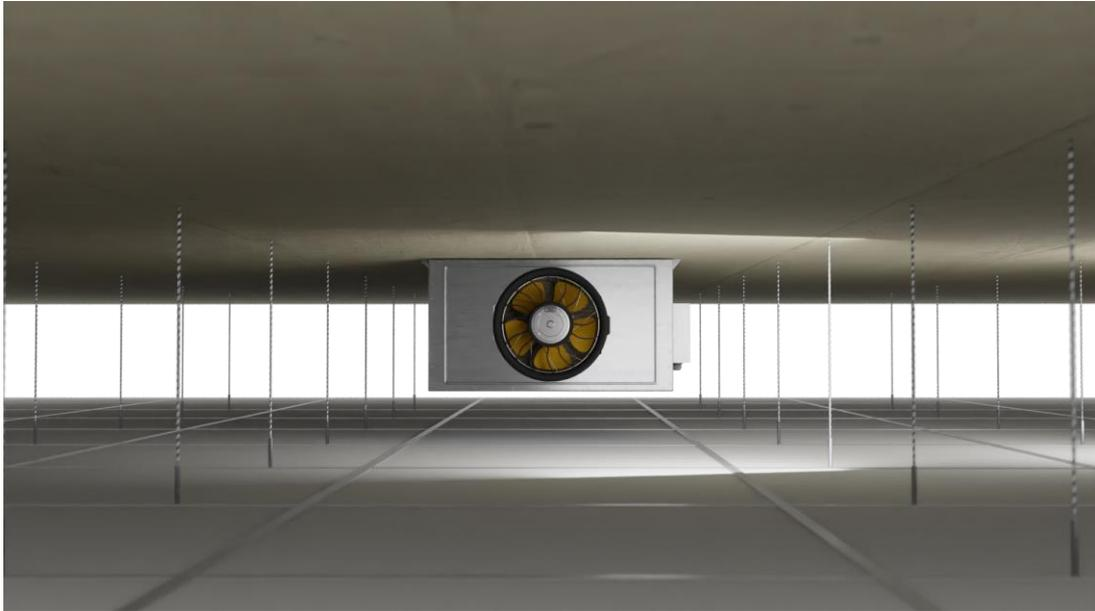
*Figura 22: Módulo instalado en falso techo, vista frontal conducto de impulsión [Elaboración propia, Blender]*
