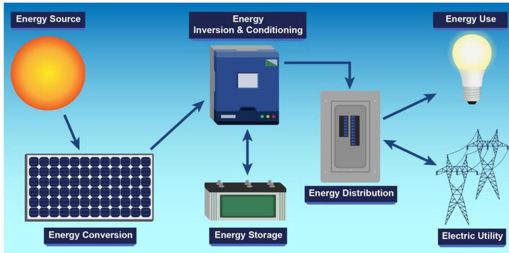
*Ilustración 1: Diagrama básico de un sistema solar fotovoltaico [1]*
