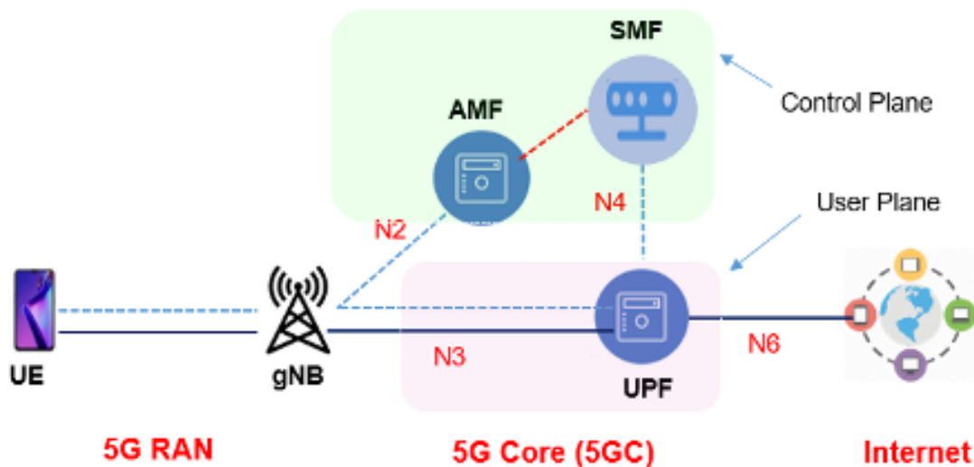
Ilustración 1. Componentes principales de la arquitectura 5G [12]
