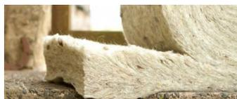
Figure 1.8: Panel semirrígido de fibra natural (lana de oveja o cáñamo). Fuente: Impertechos [131].
