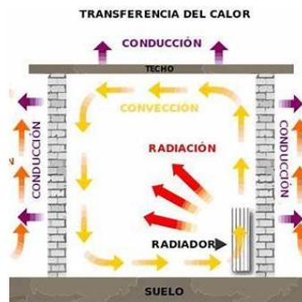
Figure 1.1: Esquema de los mecanismos de transferencia de calor en un cerámico. Fuente: Wikimedia Commons [216].
