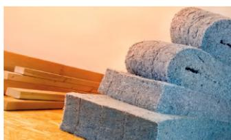
Figure 1.10: Manta de aislamiento térmico de denim reciclado. Fuente: Energía y Habitabilidad 3.0 [109].
