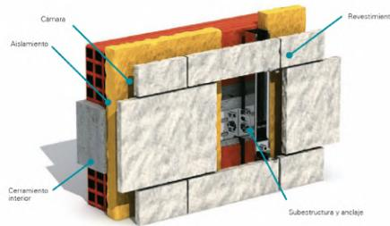
Figure 1.13: Esquema de las capas de una fachada ventilada. Fuente: ATI Asesores [61].
