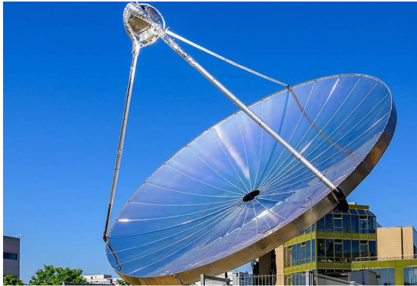
Figura 13: Reactor Solar con sistema Fotoelectroquímico incorporado (EPFL, 2023)
