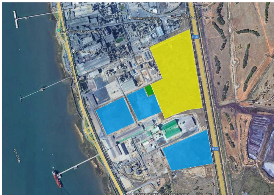
Ilustración 5: Zonas de fotoelectrocátalisis (azul), solar (amarillo) y electrolizadores (verde)
