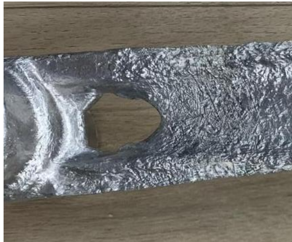
Ilustración 112: Detalle de rugosidad y falta de llenado. Fuente propia.
